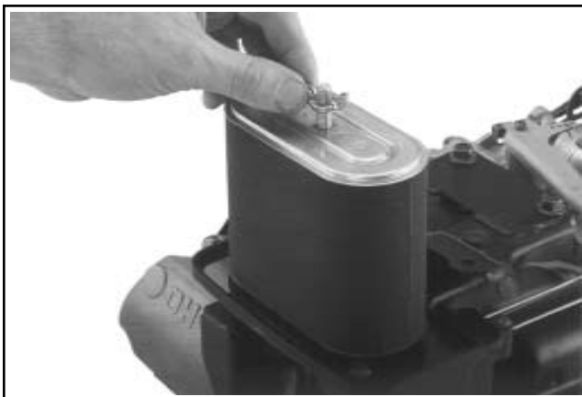
Figura 11-107. Installazione dell'elemento del filtro dell'aria, del prefilto e del dado ad alette.
