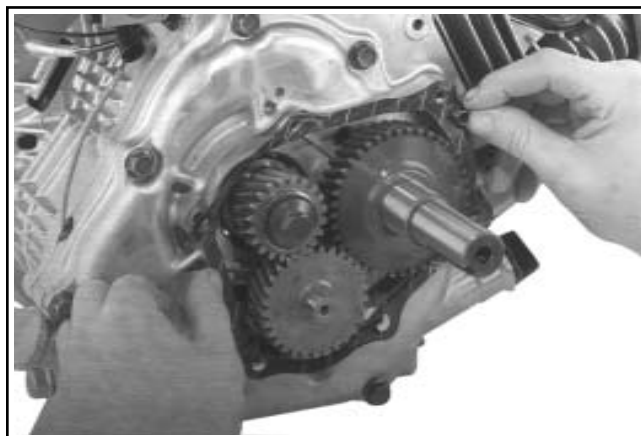
Figura 11-35. CS8.5-12. Installazione di perni di riferimento e guarnizione.
