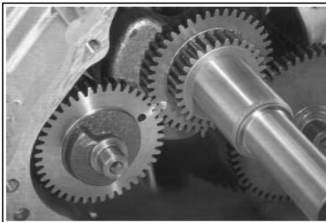
Figura 11-17. CS8.5-12. Allineamento dei segni di fasatura su albero del bilanciante ed albero a gomiti.
