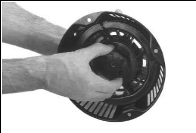
Figura 7-10. Montaggio della puleggia del sistema di avviamento sulla sede.
