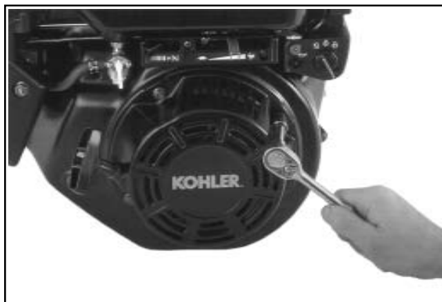
Figura 7-2. Installazione del sistema di avviamento a strappo.
