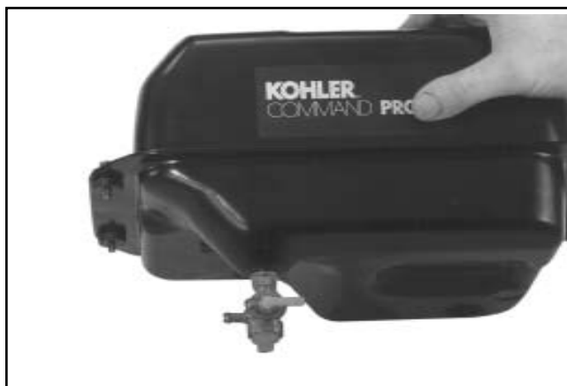
Figura 11-110. CS4, CS6, CS8.5 (n° spec. 92xxxx), CS10 e CS12. Orientamento della valvola di intercettazione.
