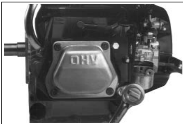
Figura 11-80. CS8.5-12. Serraggio delle viti.
