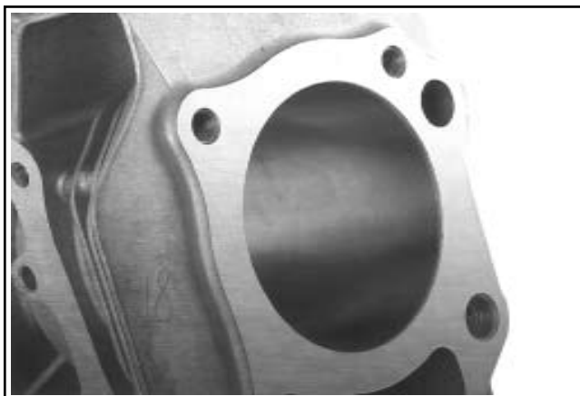
Figura 10-7. Aspetto dell'alesaggio dopo l'alesatura.
