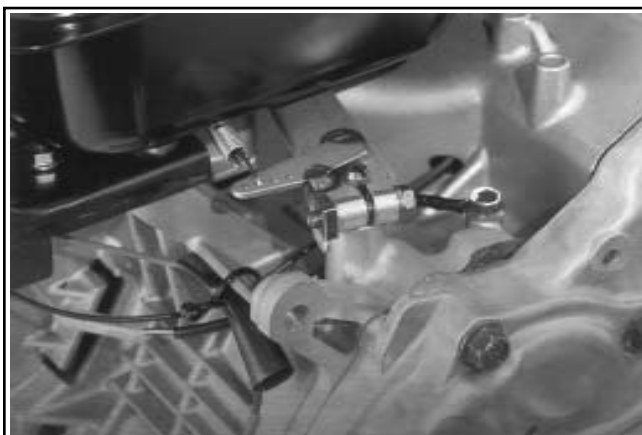
Figura 9-24. CS8.5 (n° spec. 92xxxx), CS10 e CS12. Posizione del conduttore di terra.
