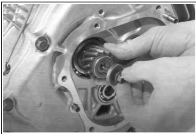
Figura 11-48. Installazione dell'ingranaggio dell'albero a gomiti, del bullone di montaggio e della rondella.
