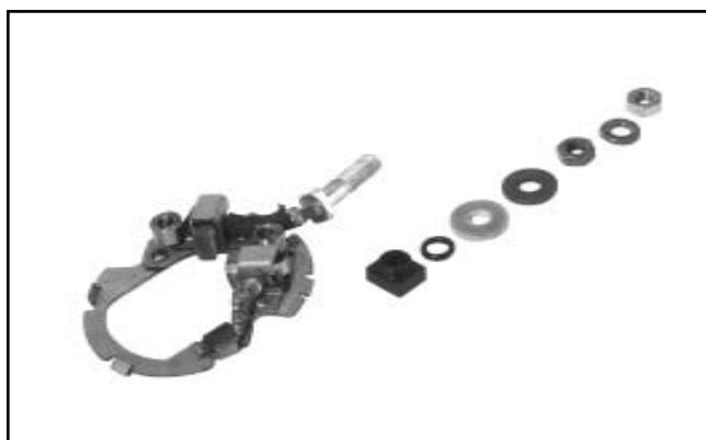
Figura 8-52. Piastra delle spazzole e componenti di estremità.
