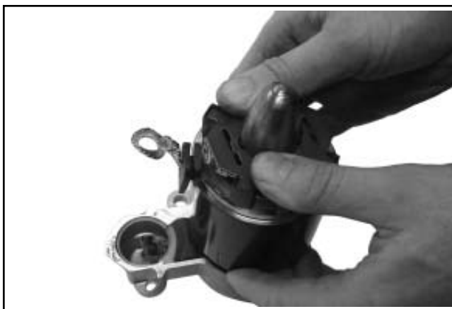
Figura 8-67. Installazione del telaio con il gruppo della piastra delle spazzole.
