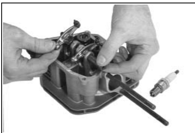
Figura 9-42. CS8.5 (n° spec. 92xxxx), CS10 e CS12. Rimozione di bilancieri e candela.
