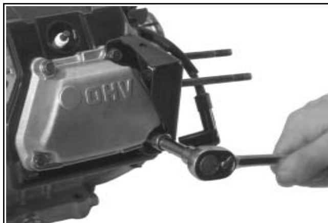
Figura 9-36. Rimozione delle viti del coprivalvole sui modelli con staffa di supporto attaccata.
