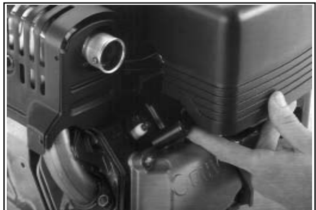
Figura 9-1. Scollegamento del conduttore della candela.
