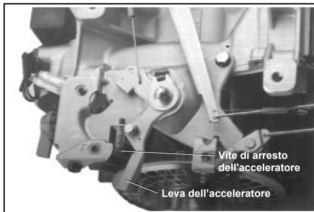
Figura 5-15. CS8.5 (n° spec. 92xxxx), CS10 e CS12. Vite di arresto dell'acceleratore/leva dell'acceleratore - Particolari.
