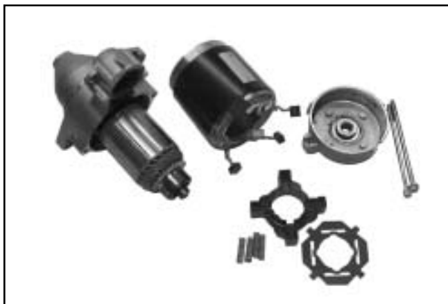
Figura 8-59. Motorino di avviamento - Smontato.
