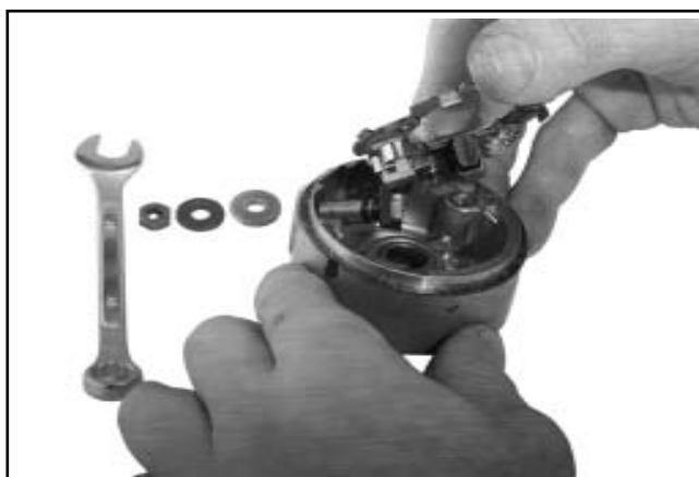
Figura 8-43. Rimozione della piastra delle spazzole.
