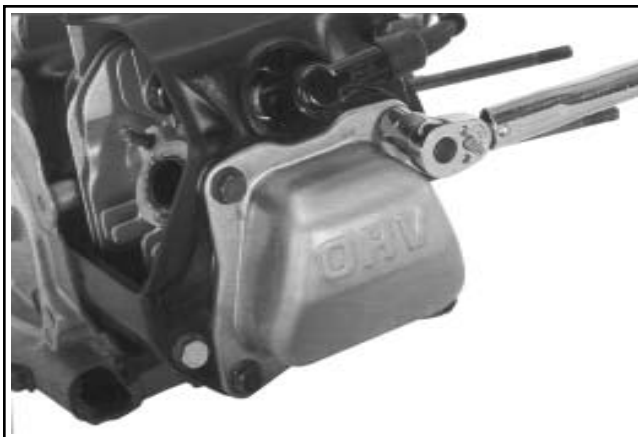
Figura 11-78. CS4, CS6, CS8.5 (n° spec. 95xxx). Serraggio delle viti sul copri valvole.
