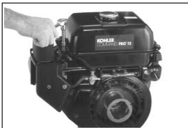
Figura 11-111. Serraggio delle viti di montaggio del serbatoio del carburante.
