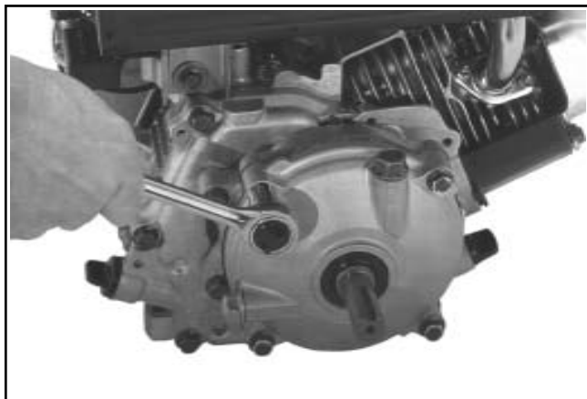
Figura 9-64. Allentamento delle viti dal coperchio della scatola della riduzione.
