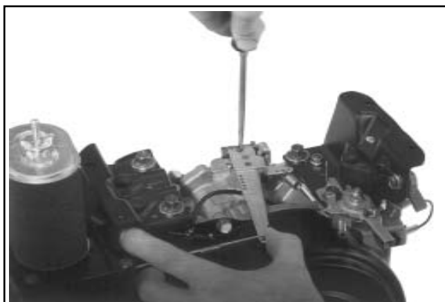
Figura 11-108. CS6 e CS4. Registrazione del regolatore.
