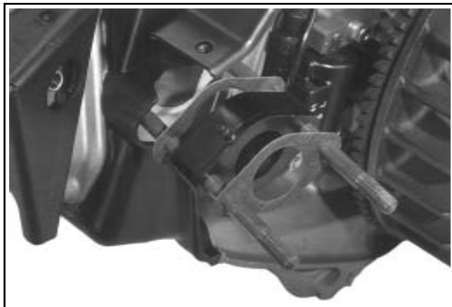
Figura 11-100. Distanziale del carburatore e guarnizioni.
