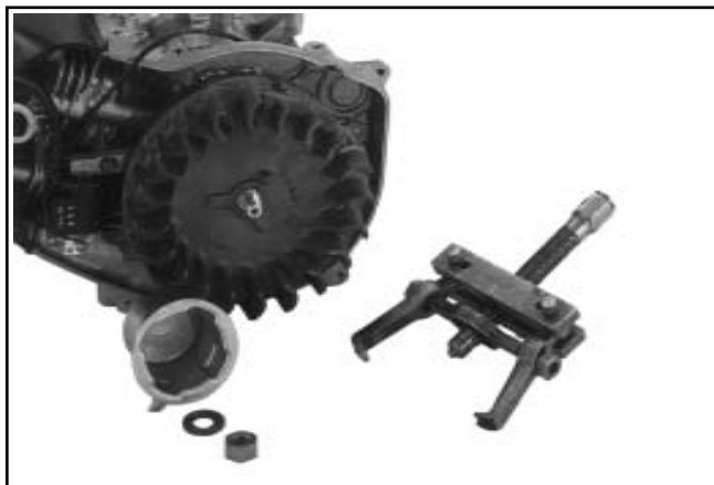
Figura 9-50. CS4 e CS6. Rimozione del volano con un estrattore di tipo esterno.
