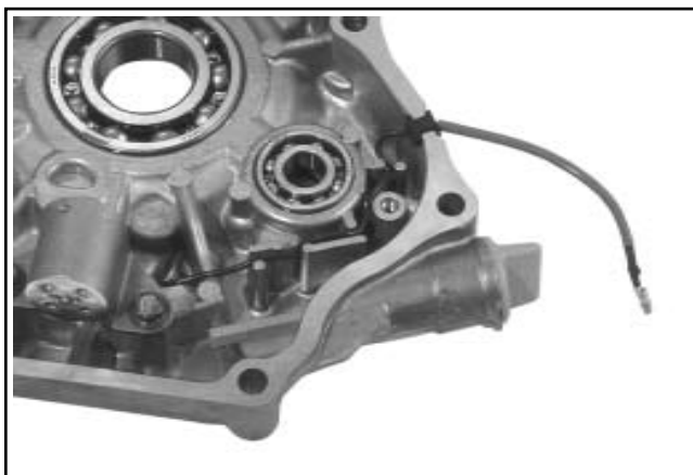
Figura 11-18. Montaggio del misuratore Oil Sentry™ e percorso del conduttore - Particolari.
