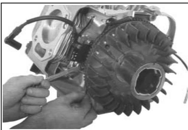
Figura 11-62. CS8.5-12. Regolazione del traferro.
