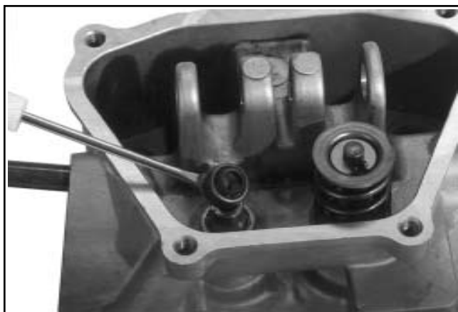
Figura 9-44. Rimozione della tenuta sullo stelo della valvola di aspirazione.
