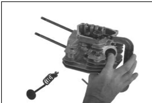
Figura 9-43. Smontaggio dei gruppi delle valvole.
