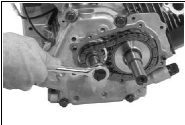
Figura 9-58. CS4, CS6. Rimozione della vite dall'albero a gomiti.
