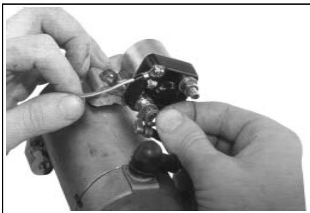
Figura 8-56. Installazione dei collegamenti del solenoide.
