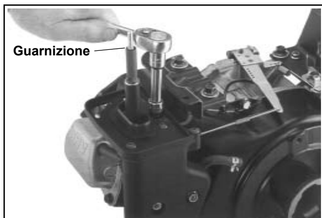
Figura 11-104. CS6 e CS4. Installazione della base del filtro dell'aria.
