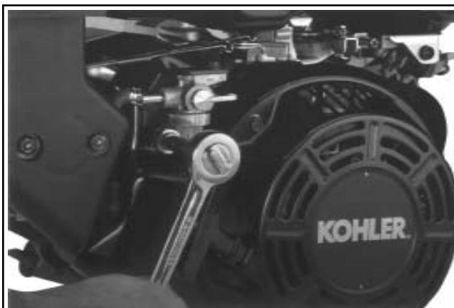
Figura 11-114. CS8.5 (n° spec. 95xxxx). Montaggio della valvola di intercettazione.
