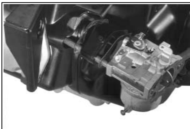
Figura 9-16. Rimozione di carburatore, guarnizioni e distanziale.
