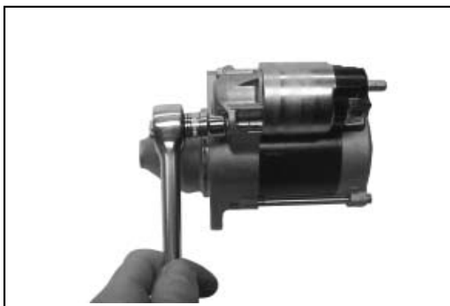
Figura 8-69. Installazione dei bulloni passanti.
