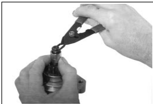
Figura 8-35. Rimozione dell'anello di sicurezza.
