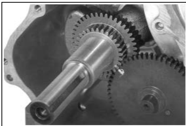
Figura 11-16. CS8.5-12. Allineamento dei segni di fasatura su albero a camme ed albero a gomiti.
