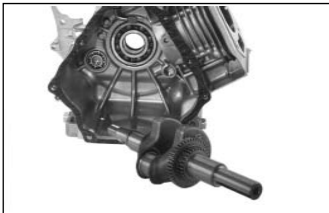
Figura 9-86. Rimozione dell'albero a gomiti.
