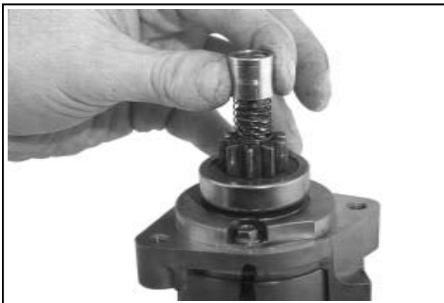
Figura 8-37. Installazione dei componenti di innesto.
