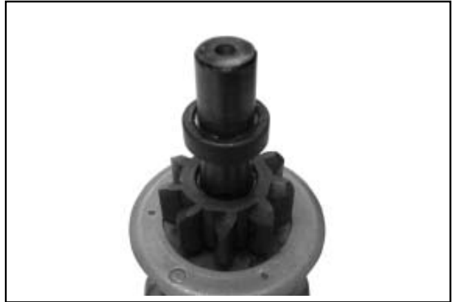
Figura 8-62. Bloccare il collare intorno all'anello di sicurezza.
