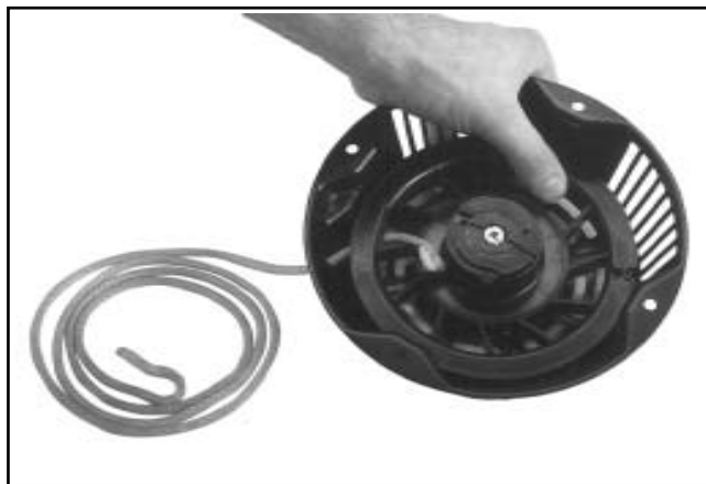
Figura 7-5. Installazione della funicella.
