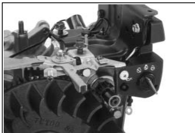
Figura 9-27. CS8.5 (n° spec. 92xxxx), CS10 e CS12. Staffa di montaggio destra del serbatoio - Particolari.
