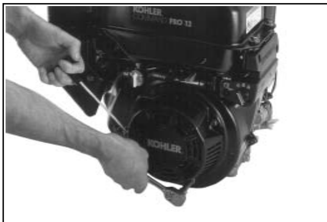
Figura 7-3. Serraggio delle viti di montaggio con i nottolini ingranati.
