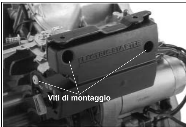
Figura 9-21. Viti di montaggio del pannello di copertura.
