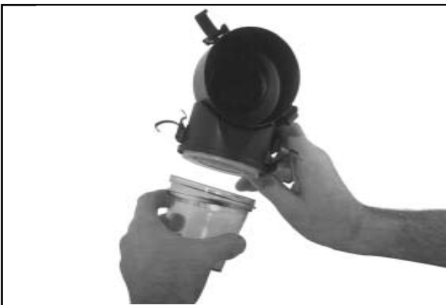
Figura 4-9. Rimozione della camera inferiore - servizio gravoso.
