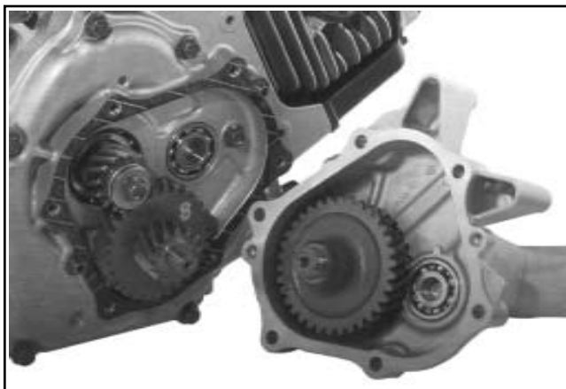
Figura 9-71. Rimozione del coperchio della scatola.
