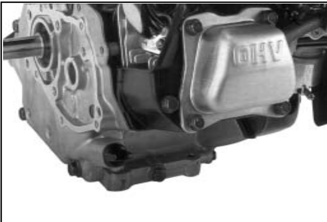
Figura 6-5. CS4, CS6. Tappo di livello/riempimento dell'olio - A sinistra.
