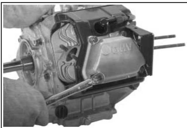
Figura 11-79. CS8.5-12. Serraggio delle viti del copri valvole.
