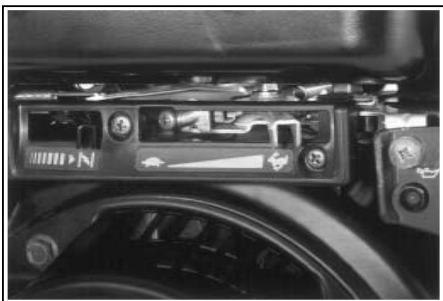
Figura 11-119. CS8.5 (n° spec. 92xxxx), CS10 e CS12. Vite di regolazione regime massimo.
