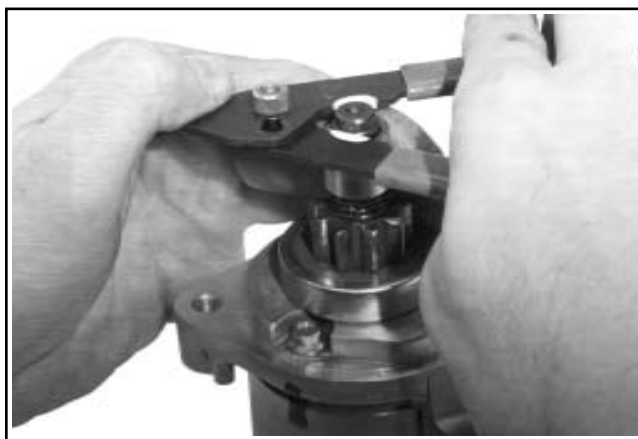
Figura 8-38. Installazione dell'anello di sicurezza.
