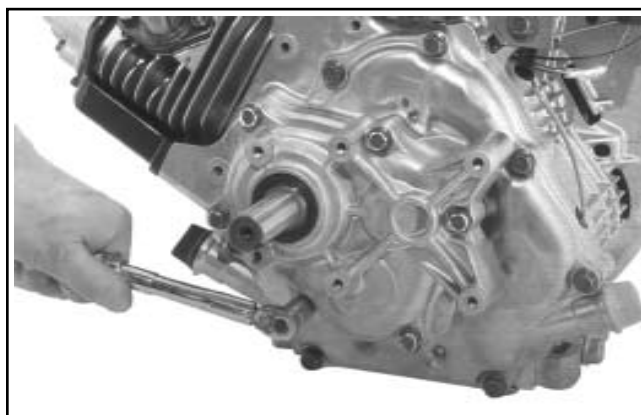
Figura 11-37. CS8.5-12. Serraggio delle viti di montaggio sul coperchio.
