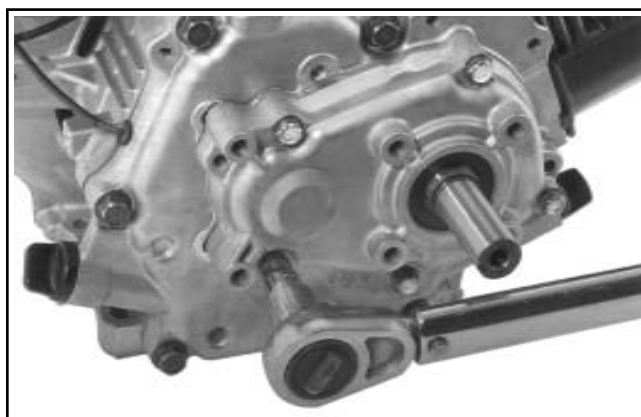
Figura 11-36. CS6 e CS4. Serraggio delle viti di montaggio sul coperchio.
