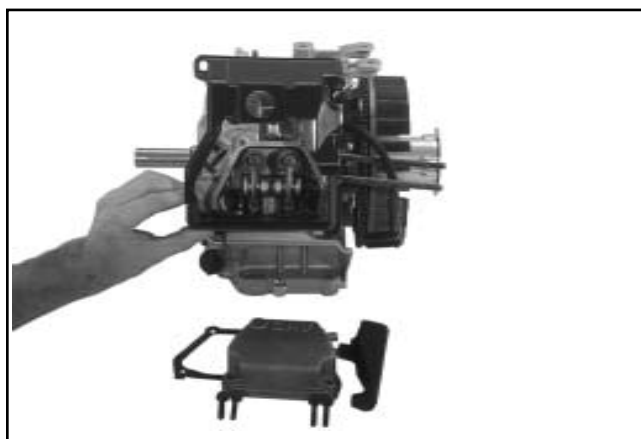
Figura 9-38. Coprivalvole, guarnizione e pannello dell'aria rimossi.
