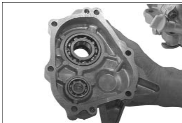
Figura 11-25. CS8.5-12. Installazione del cuscinetto.
