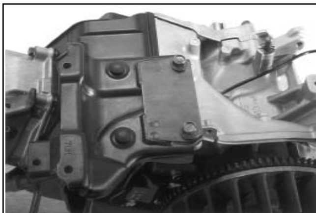
Figura 9-35. CS8.5 (n° spec. 92xxxx), CS10 e CS12. Staffa di montaggio sinistra del serbatoio - Particolari.
