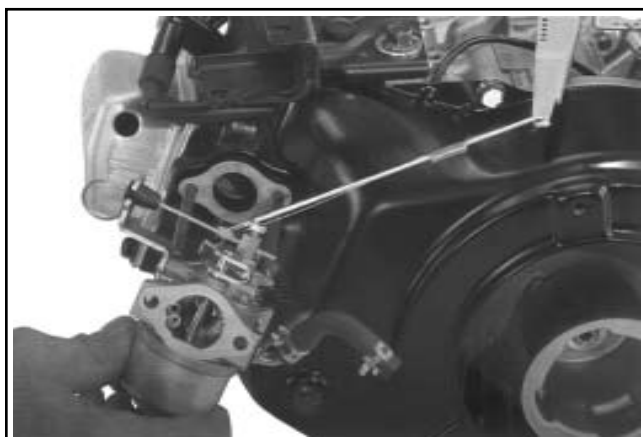
Figura 11-101. CS6 e CS4. Montaggio della tiranteria.
