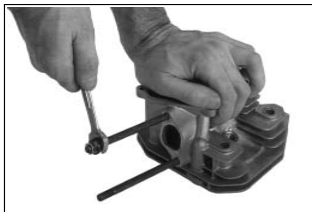
Figura 9-45. Rimozione dei perni di fissaggio del carburatore.
