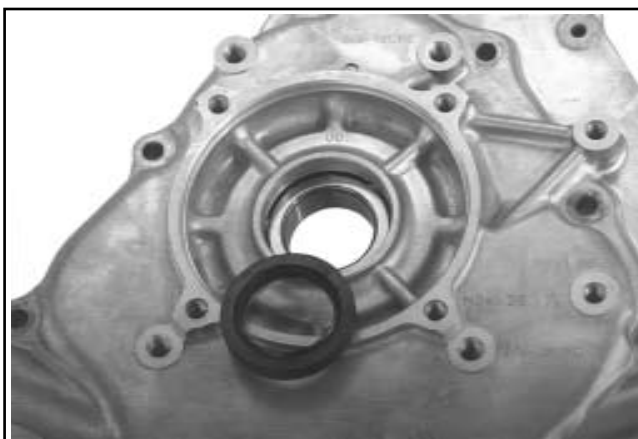
Figura 9-80. Rimozione della guarnizione di tenuta dell'albero motore.
