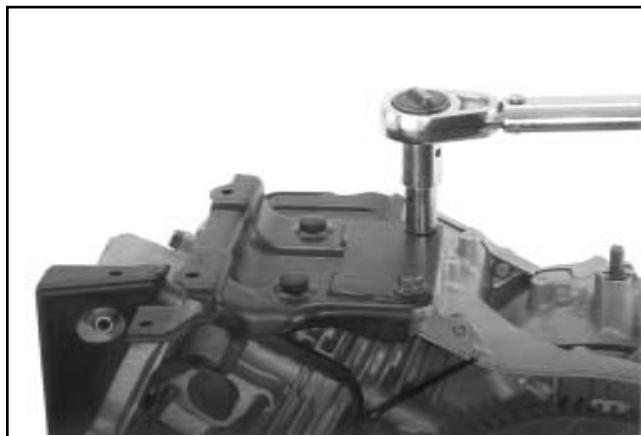
Figura 11-82. CS8.5 (n° spec. 92xxxx), CS10 e CS12: Montaggio del supporto del serbatoio del carburante di sinistra.
