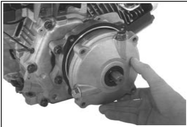
Figura 11-44. Installazione del gruppo del coperchio.
