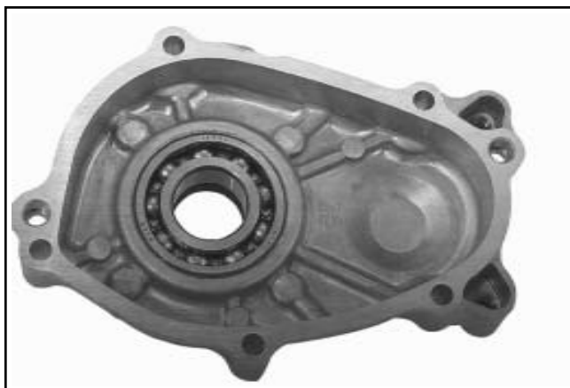
Figura 11-24. CS6 e CS4. Installazione del cuscinetto.
