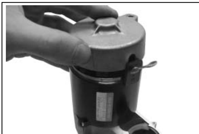
Figura 8-68. Installazione del cappuccio di estremità.
