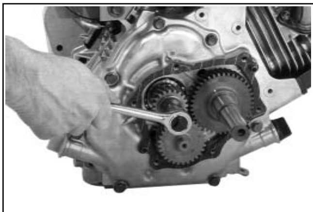
Figura 9-59. CS8.5-CS12. Rimozione della vite dall'albero a gomiti.
