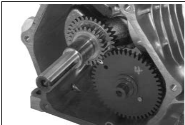
Figura 11-15. CS6 e CS4. Allineamento dei simboli di fasatura su albero a camme ed albero a gomiti.
