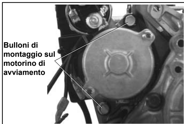
Figura 9-30. Bulloni sul motorino di avviamento sui modelli con motorini con solenoide.
