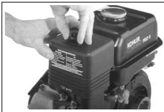
Figura 4-3. Rimozione del pomello sul coperchio - configurazione standard.
