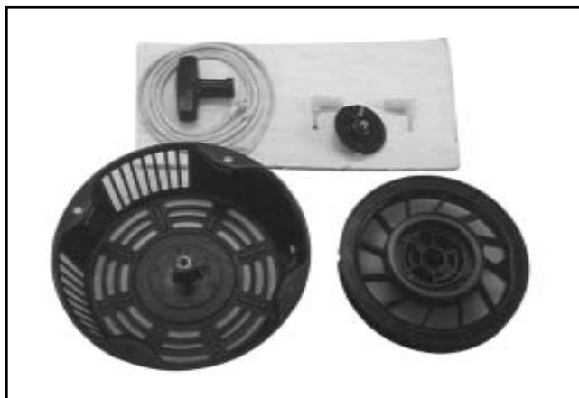
Figura 7-9. Sistema di avviamento a strappo - Smontato.
