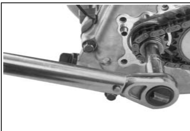
Figura 11-31. Serraggio del bullone di montaggio.
