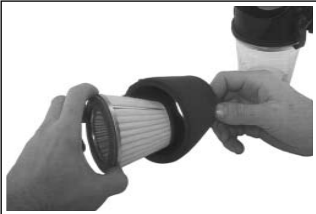
Figura 4-8. Rimozione del prefiltro - servizio gravoso.
