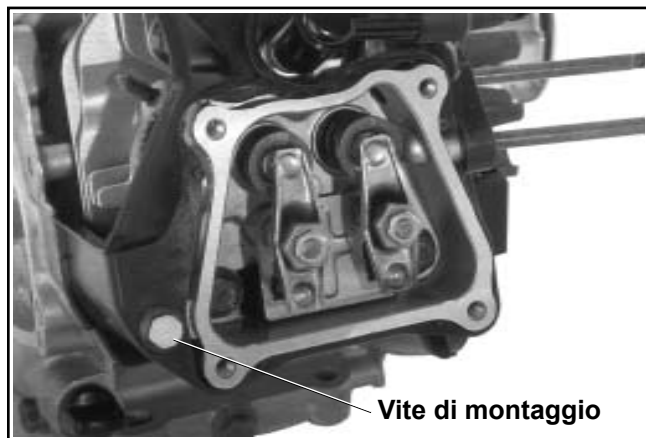
Figura 9-39. CS4 e CS6. Posizione della vite di montaggio.
