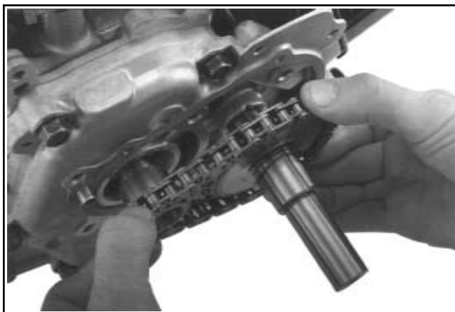
Figura 9-60. CS4, CS6. Rimozione di corone dentate e catena.
