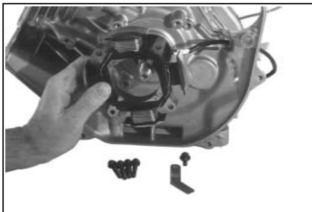
Figura 9-53. Rimozione delle viti di montaggio e dello statore.
