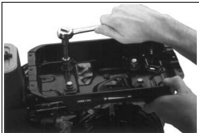
Figura 11-112. CS8.5 (n° spec. 95xxxx). Installazione del supporto del serbatoio del carburante.
