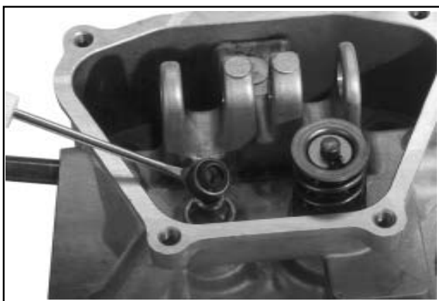
Figura 11-63. Tenuta dello stelo della valvola di aspirazione.
