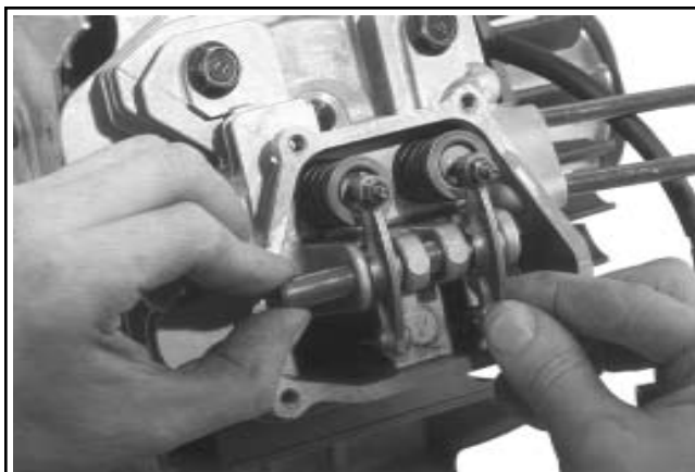
Figura 11-71. CS8.5 (n° spec. 92xxxx), CS10 e CS12: Montaggio di bilancieri e albero di rotazione.
