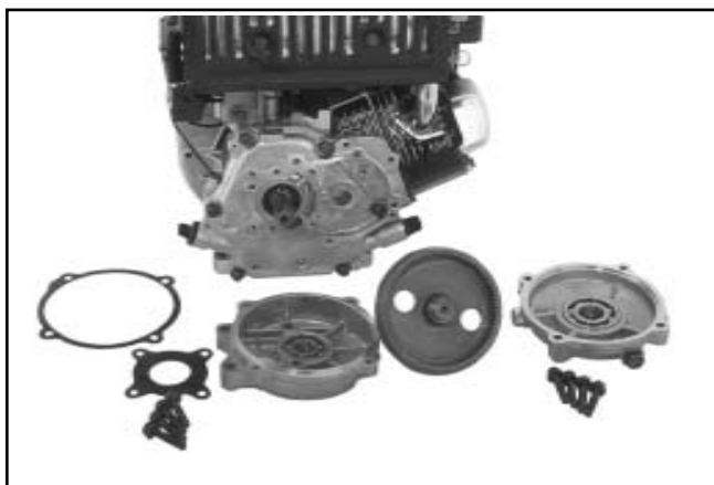
Figura 9-69. CS4, CS6. Componenti del gruppo di riduzione 6:1.
