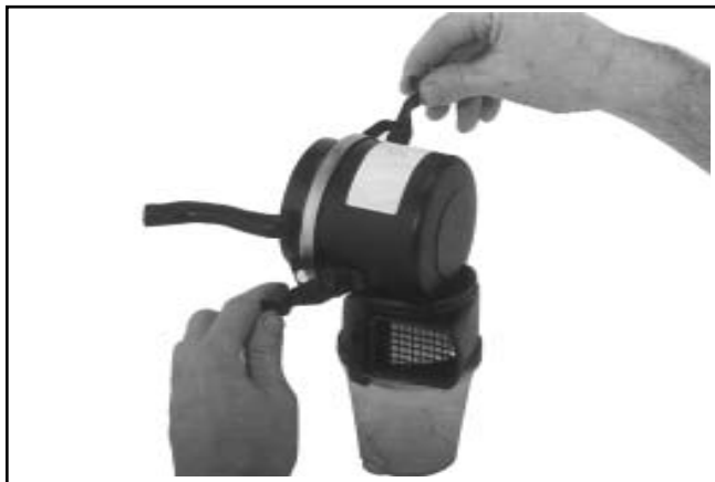
Figura 4-4. Sbloccaggio dei fermi - configurazione per servizio gravoso.
