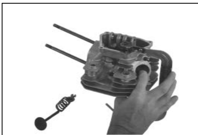
Figura 11-64. Installazione delle valvole con il compressore per le molle delle valvole.
