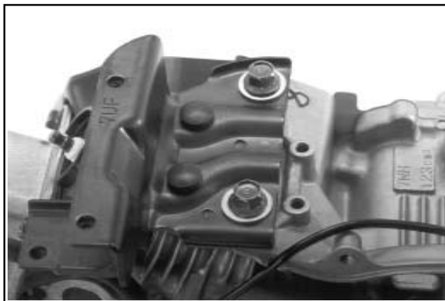
Figura 9-34. CS4, CS6. Staffa di montaggio sinistra del serbatoio - Particolari.
