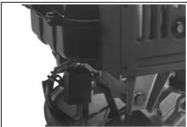
Figura 9-25. CS8.5 (n° spec. 95xxxx). Posizione del conduttore di terra.
