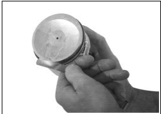
Figura 10-15. Misurazione del gioco laterale dei segmenti del pistone.
