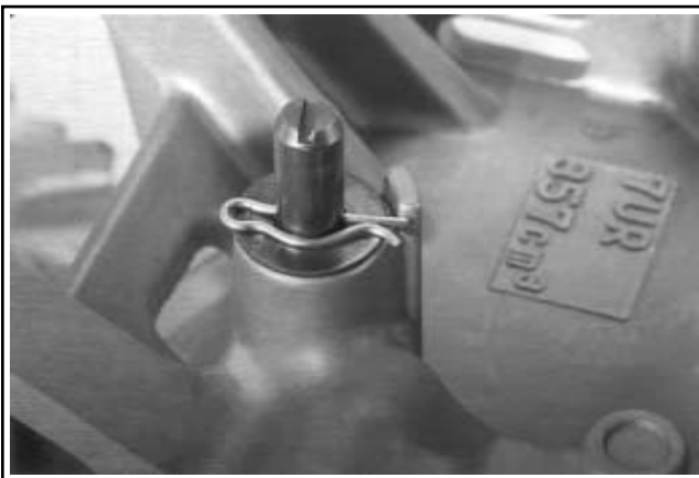
Figura 11-7. CS8.5-12. Installazione del perno.
