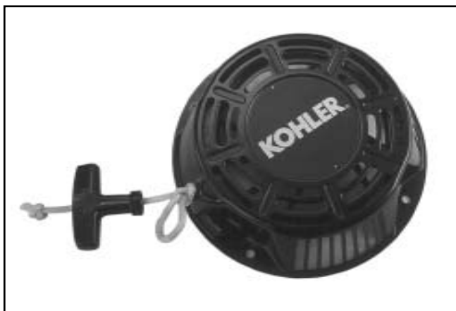
Figura 7-4. Rimozione dell'impugnatura del sistema di avviamento.
