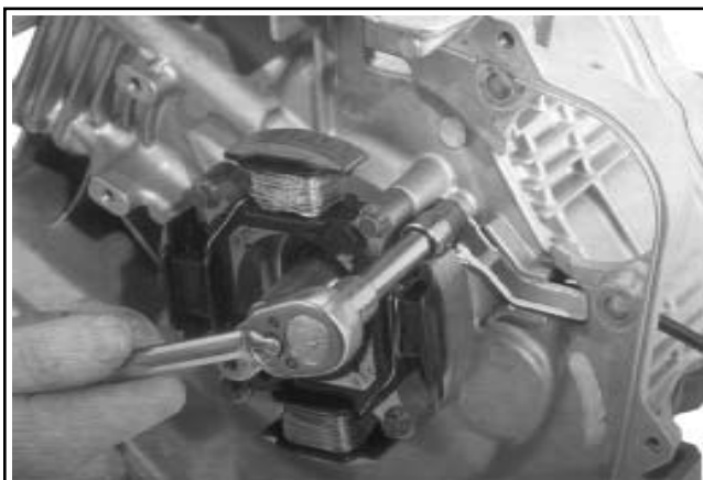
Figura 11-56. Installazione del riparo.
