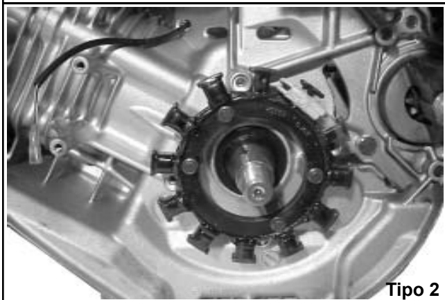
Figura 11-54. Installazione delle viti di montaggio dello statore.
