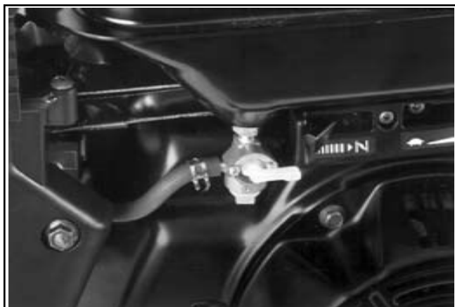
Figura 9-2. Valvola di intercettazione del carburante.
