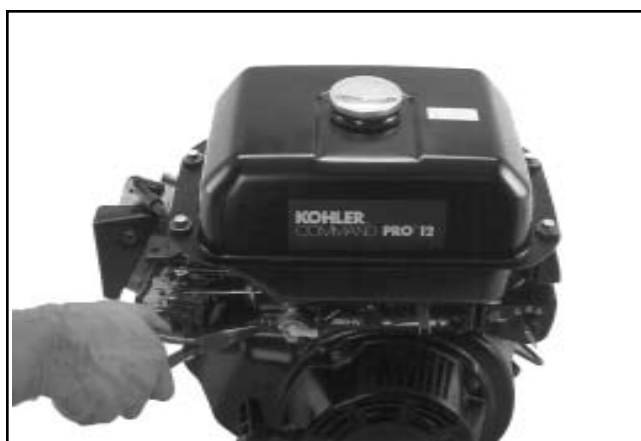
Figura 9-9. Scollegamento della linea di alimentazione sui motori CS4, CS6, CS8.5 (n° spec. 92xxxx), CS10 e CS12.
