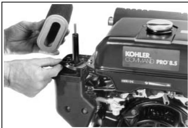
Figura 4-14. Tampone di base in gomma sostituibile.
