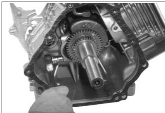
Figura 9-84. Rimozione dei bulloni dalla biella.
