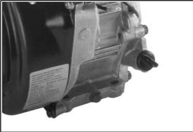
Figura 6-4. CS4, CS6. Tappo di livello/riempimento dell'olio - A destra.
