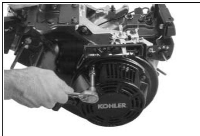
Figura 9-18. Rimozione delle viti di fissaggio del sistema di avviamento.
