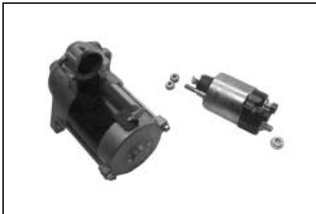
Figura 8-58. Motorino di avviamento con solenoide smontato.
