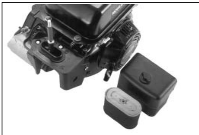
Figura 9-6. CS8.5 (n° spec. 92xxxx), CS10 e CS12. Base del filtro dell'aria.
