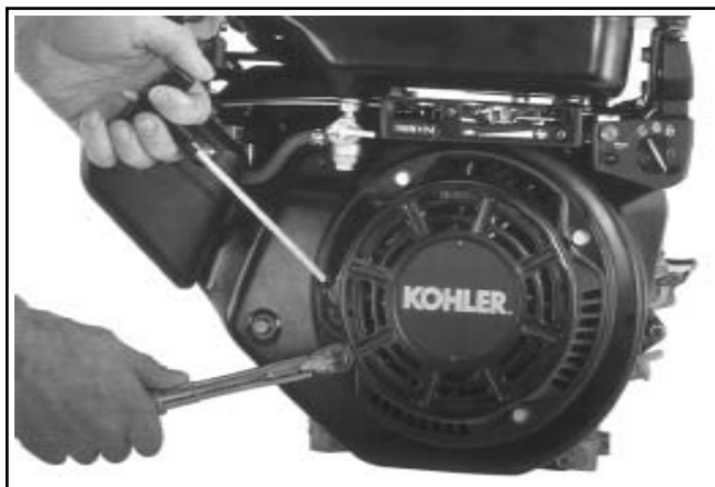
Figura 11-116. Innesto dei nottolini e serraggio delle viti di montaggio.
