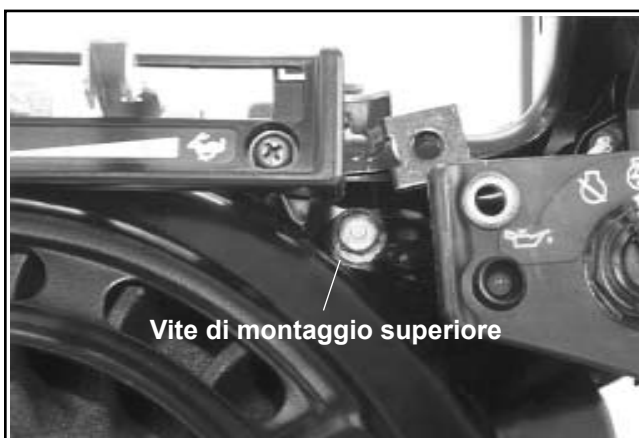
Figura 9-22. CS8.5 (n° spec. 92xxxx), CS10 e CS12. Vite di montaggio in alto a destra.
