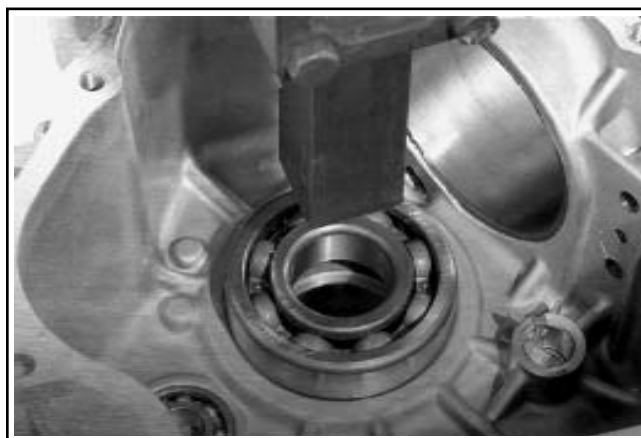
Figura 11-1. Installazione dei cuscinetti con una pressa.
