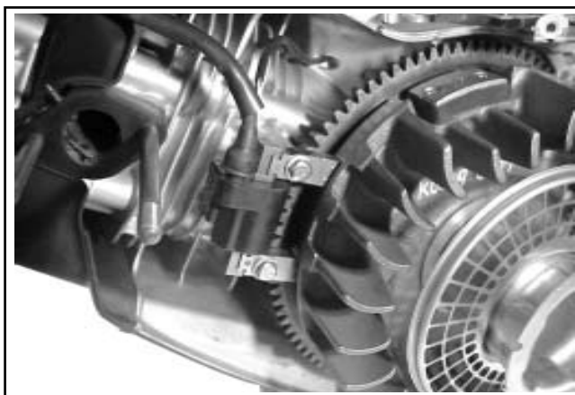
Figura 9-46. Configurazione del modulo/volano ad avviamento elettrico (alcuni modelli).
