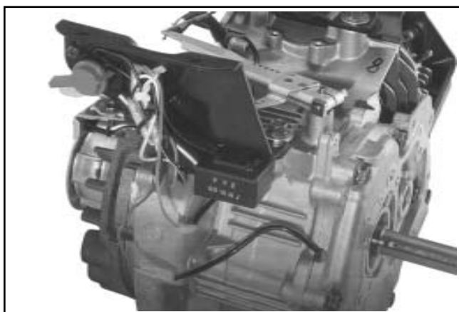
Figura 11-93. CS8.5 (n° spec. 92xxxx), CS10 e CS12. Ricollegare i conduttori elettrici.
