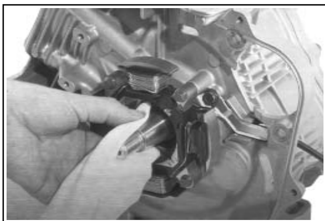
Figura 11-57. Estremità conica dell'albero motore pulita ed asciutta.
