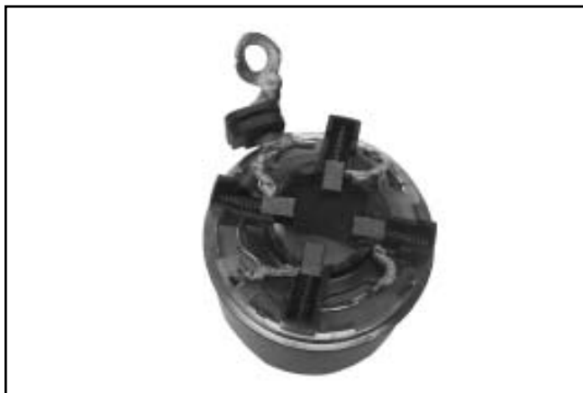
Figura 8-64. Montaggio del portaspazzole sul telaio.
