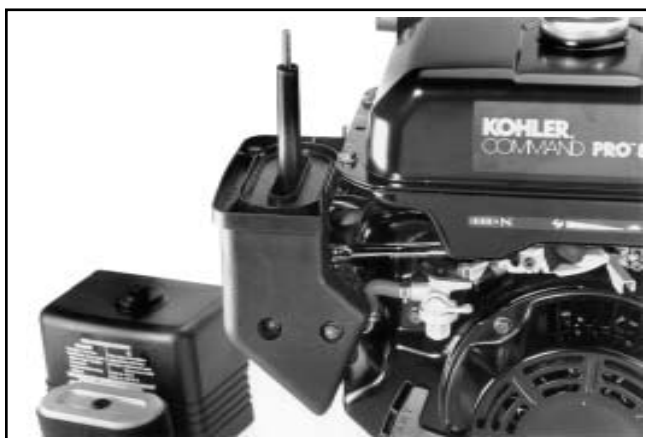
Figura 9-7. CS8.5 (n° spec. 95xxxx). Base del filtro dell'aria.
