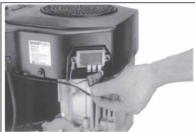
Figura 11-65. Installazione del raddrizzatore-regolatore.
