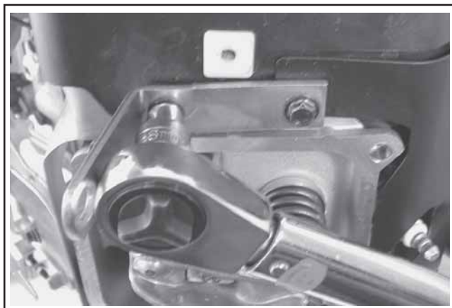
Figura 11-60. Serraggio delle viti anteriori dei deflettori esterni.
