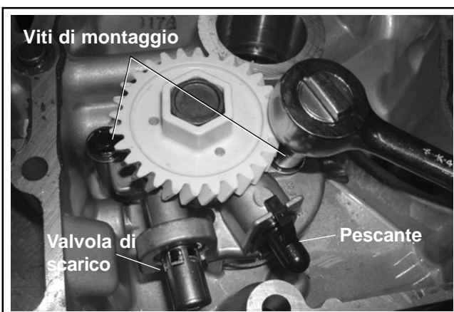
Figura 10-15. Rimozione della pompa dell'olio.
