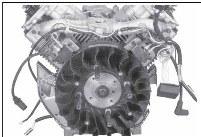
Figura 11-52. Collegamento dei cavi sulle bobine di accensione SMART-SPARK ™ .
