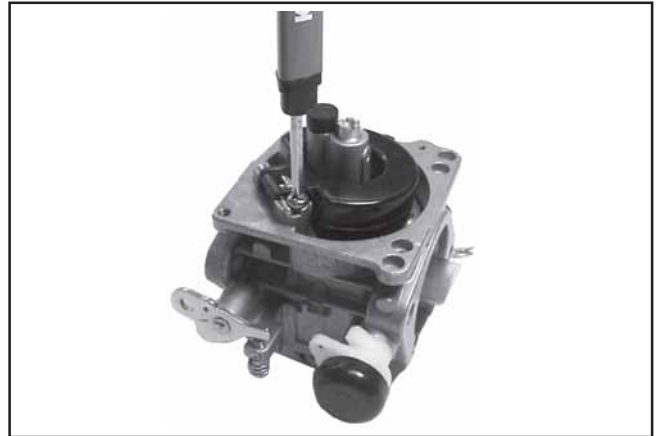
Figura 5-21. Installazione del gruppo galleggiante.
