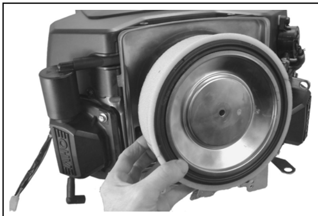
Figura 9-6. Rimozione di elemento standard e prefiltro.
