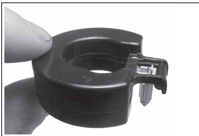
Figura 5-10. Galleggiante e spillo di ingresso.
