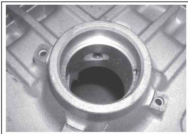
Figura 11-1. Foro per il paraolio nel carter.
