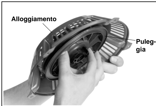
Figura 7-6. Rimozione della puleggia dall'alloggiamento.
