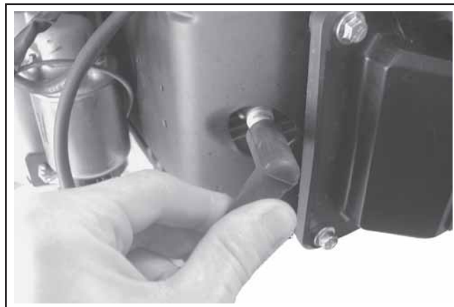
Figura 11-85. Collegamento dei cavi delle candele.
