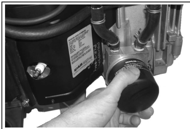
Figura 9-4. Rimozione del filtro dell'olio.
