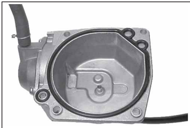
Figura 5-23. Installazione degli O-ring della vaschetta del carburante.
