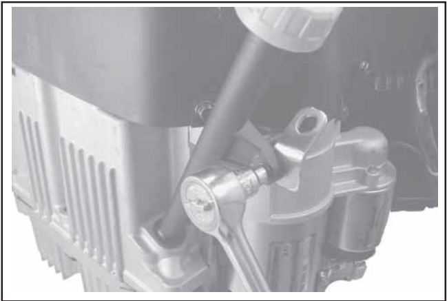
Figura 11-76. Installazione del tubo dell'astina di livello.
