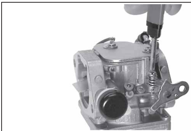
Figura 5-26. Installazione di vite di regolazione del regime e molla.
