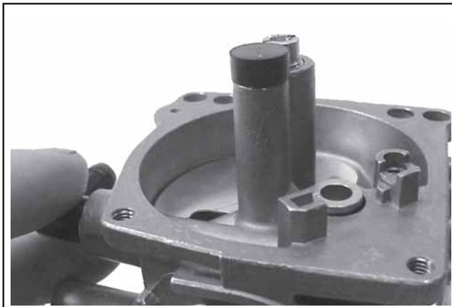
Figura 5-19. Installazione del tappo nel tubo del getto lento.
