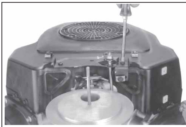
Figura 11-71. Installazione del pannello di comando.
