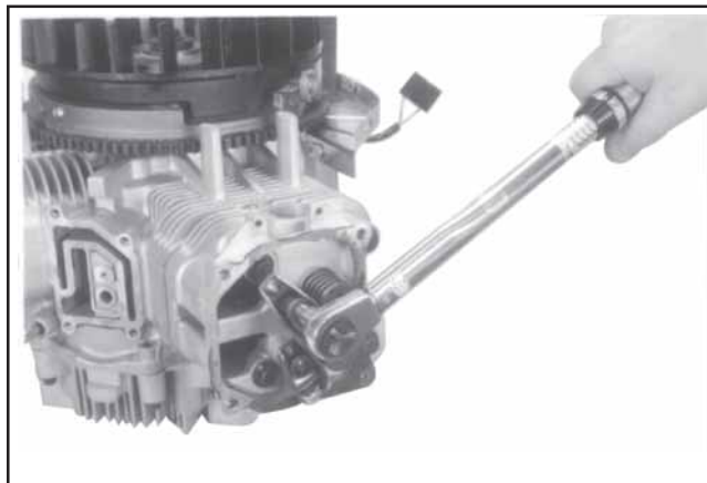
Figura 11-37. Serraggio dei dispositivi di fissaggio della testata.
