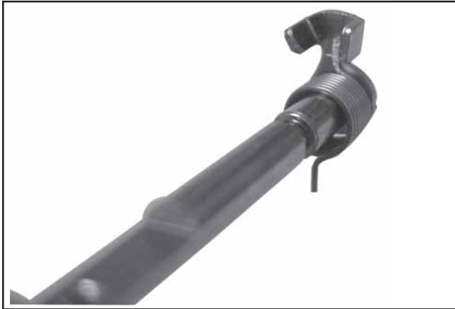
Figura 5-35. Dettagli di albero dello starter e molla.
