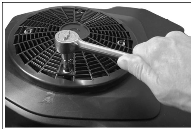
Figura 9-24. Rimozione del retino del volano.
