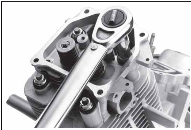
Figura 11-40. Serraggio dei dadi di montaggio della testata (con prigionieri).
