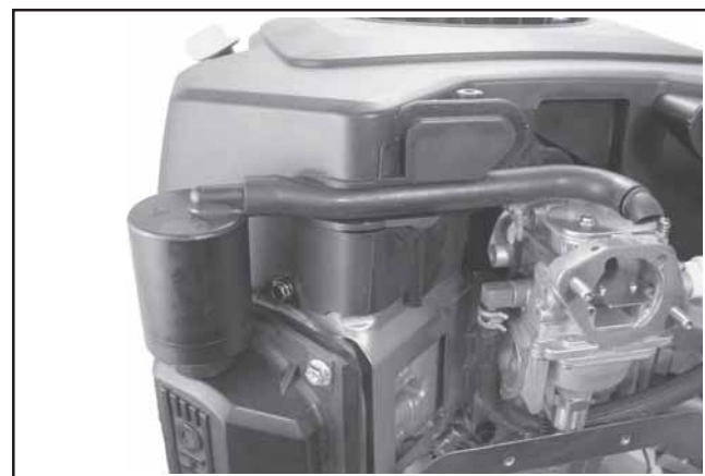
Figura 11-80. Dettagli di flessibile di sfiato e separatore.
