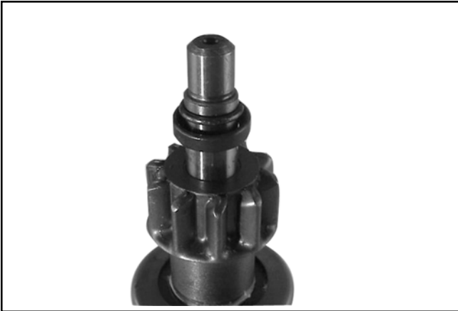
Figura 8-49. Dettaglio dell'anello di bloccaggio.
