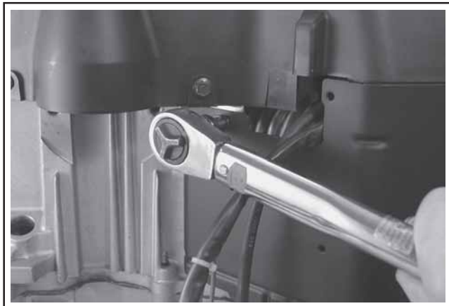
Figura 11-61. Serraggio delle viti corte per i deflettori esterni.
