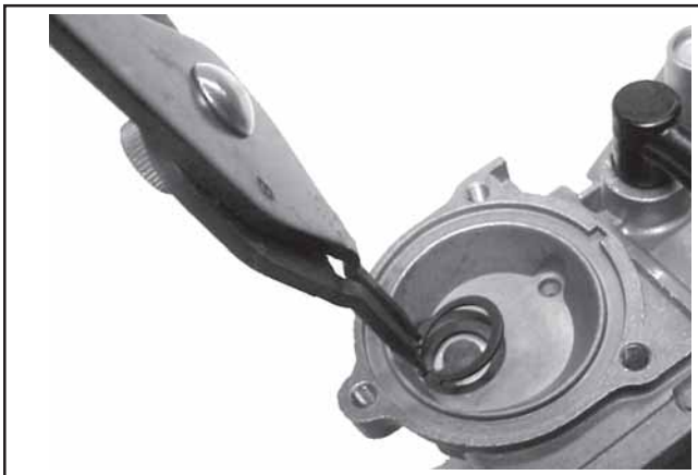
Figura 5-28. Rimozione dell'anello di fissaggio.
