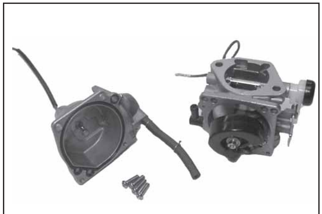
Figura 5-14. Vaschetta del carburante smontata dal carburatore.
