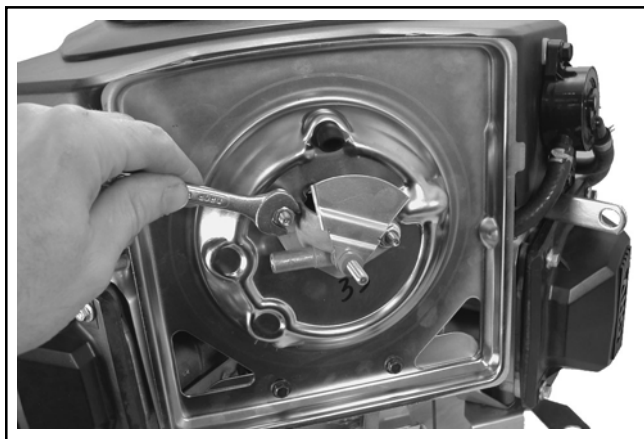
Figura 9-7. Rimozione della base del filtro dell'aria standard.
