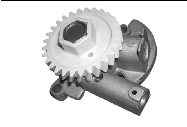
Figura 10-16. Pompa dell'olio, pescante e valvola di scarico (tipo originale).
