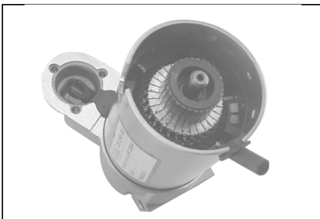
Figura 8-61. Installazione di telaio e tubo di spurgo.
