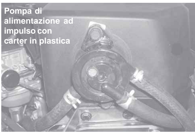
Figura 11-77. Pompa di alimentazione reinstallata.
