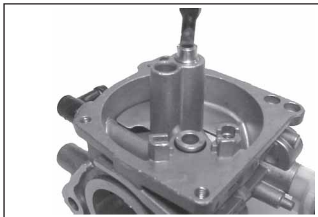
Figura 5-17. Installazione di ugello e getto principale.
