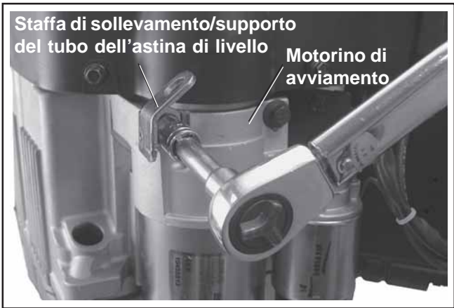
Figura 11-75. Installazione di motorino di avviamento e staffa di sollevamento.
