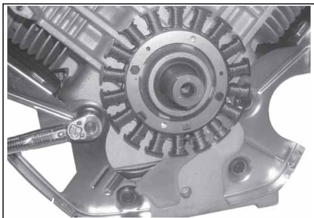
Figura 11-22. Installazione di piastre posteriori e coperchio dei cavi dello statore.
