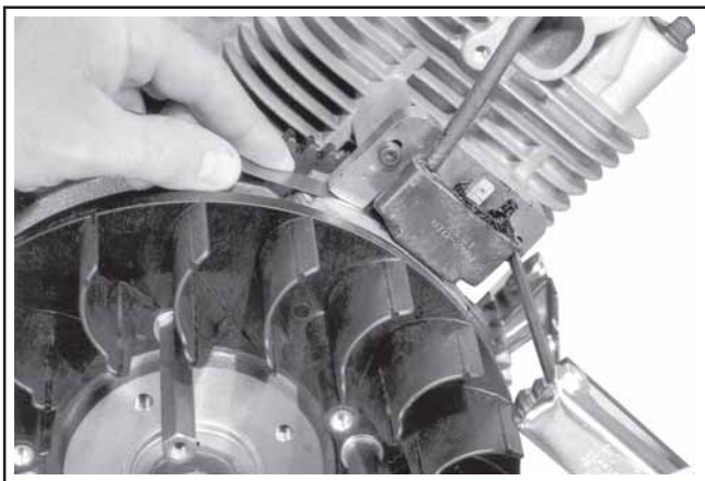
Figura 11-46. Regolazione del traferro della bobina di accensione.
