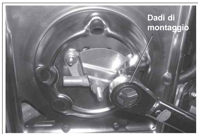
Figura 11-81. Serraggio dei dadi di montaggio di base e scodellino.
