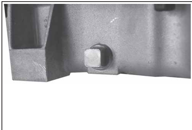
Figura 11-84. Installazione del(i) tappo(i) di spurgo dell'olio.
