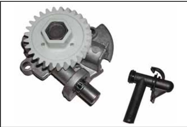
Figura 10-17. Pompa dell'olio, pescante di plastica e valvola di scarico in un unico pezzo (nuovo tipo).
