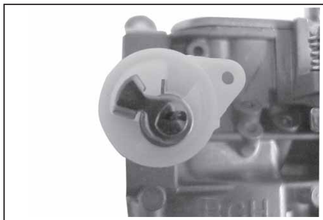
Figura 5-32. Dettagli dello starter.
