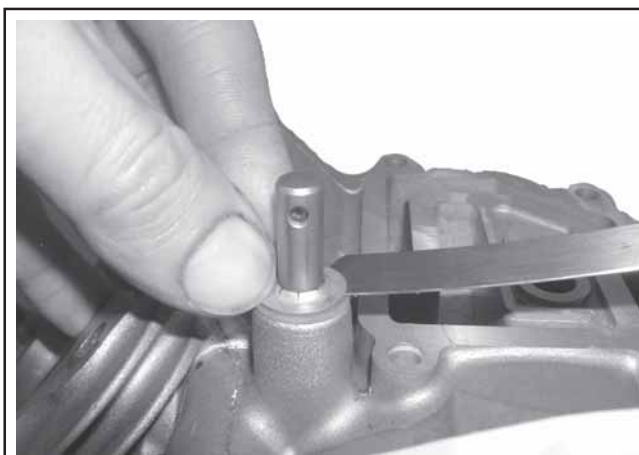
Figura 11-6. Regolazione del gioco finale dell'albero trasversale del regolatore (albero da 8 mm).
