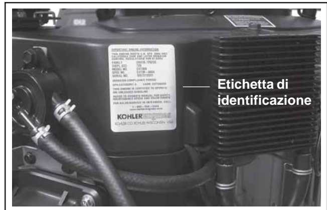
Figura 1-1. Posizione dell'etichetta di identificazione del motore.
