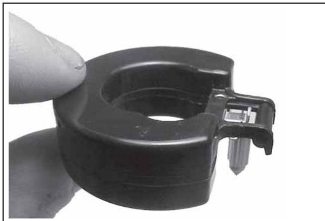
Figura 5-20. Galleggiante e spillo di ingresso.
