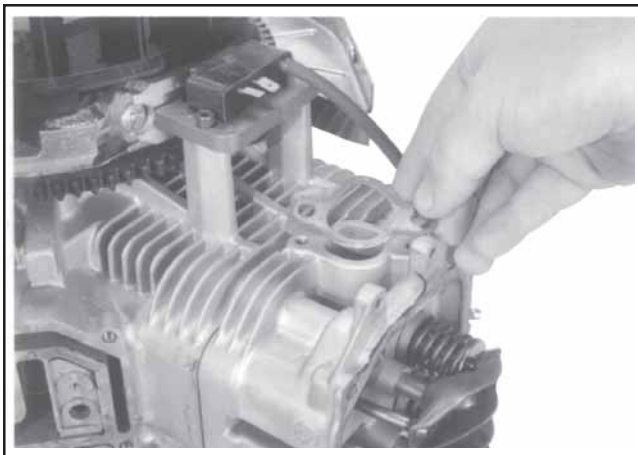
Figura 11-47. Installazione delle guarnizioni del collettore di aspirazione.
