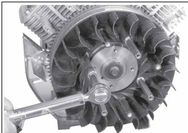
Figura 11-29. Serraggio dei supporti per il retino metallico (alcuni modelli).
