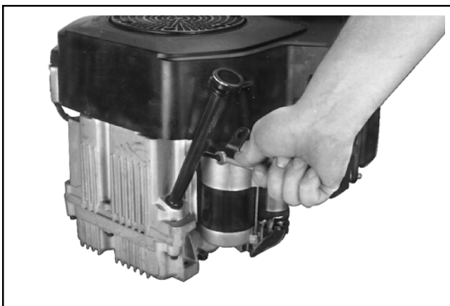
Figura 9-3. Rimozione della staffa del tubo di rifornimento dell'olio.
