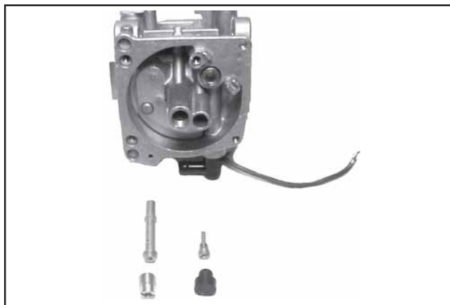
Figura 5-16. Getto principale e getto lento smontati.
