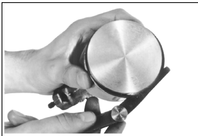
Figura 10-10. Misurazione del gioco laterale dei segmenti del pistone.
