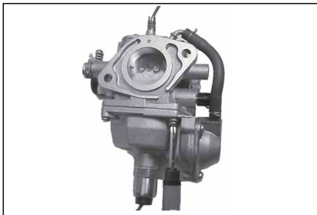
Figura 5-24. Installazione della vaschetta del carburante.
