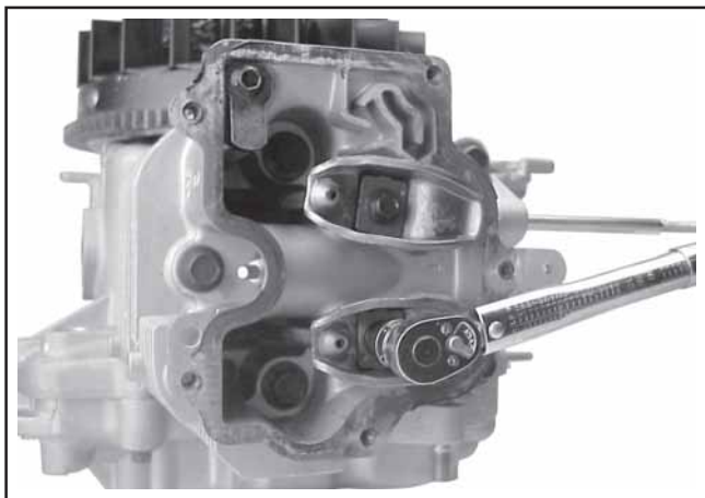
Figura 11-39. Installazione dei nuovi prigionieri all'altezza indicata.
