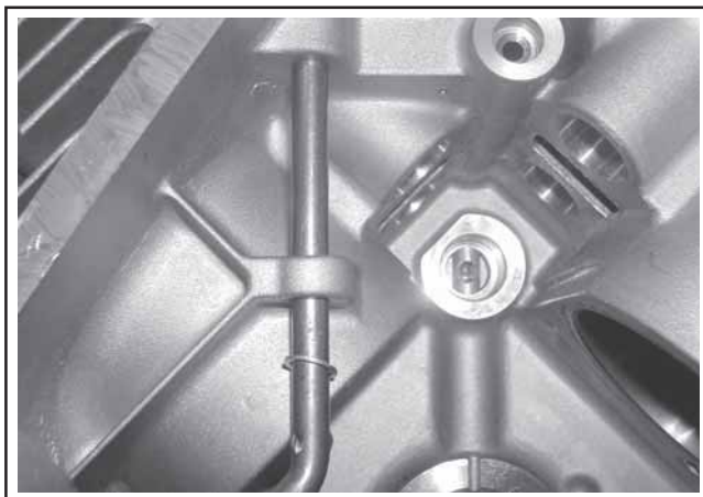
Figura 11-5. Installazione dell'albero trasversale del regolatore da 8 mm.
