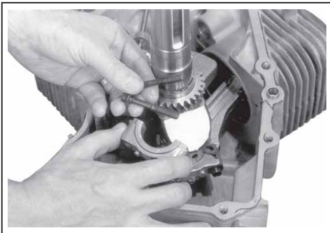
Figura 11-10. Dettagli di bullone e cappello di biella.
