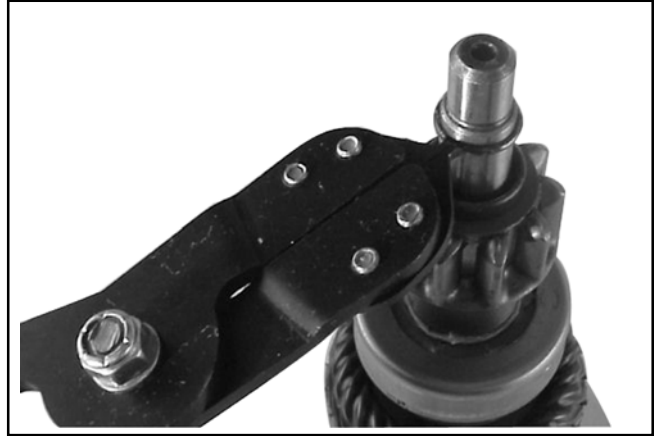
Figura 8-50. Rimozione dell'anello di bloccaggio.
