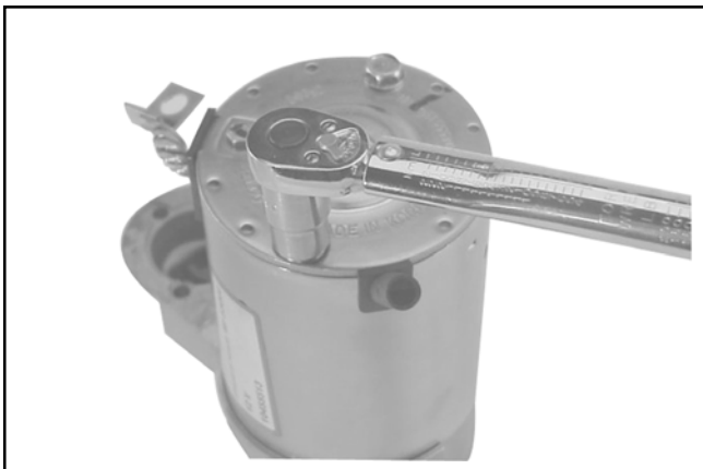
Figura 8-67. Serraggio dei bulloni passanti.
