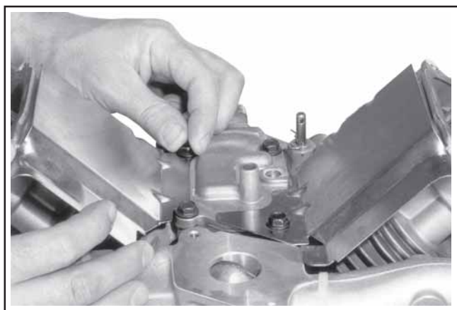
Figura 11-56. Serraggio manuale delle due viti rimanenti del coperchio.
