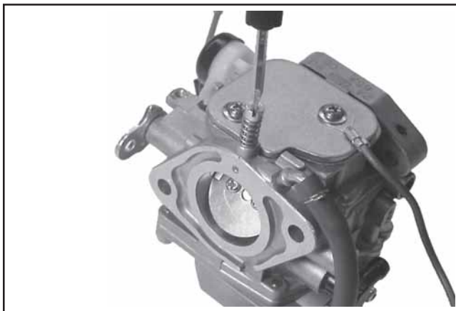
Figura 5-25. Installazione di vite di regolazione del minimo e molla.
