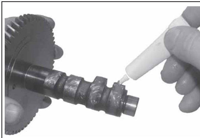
Figura 11-12. Applicazione del lubrificante per alberi a camme ai lobi delle camme.
