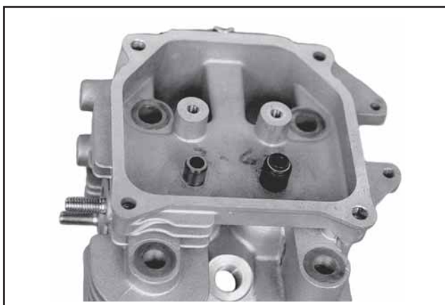
Figura 11-34. Posizione della tenuta della valvola di aspirazione.
