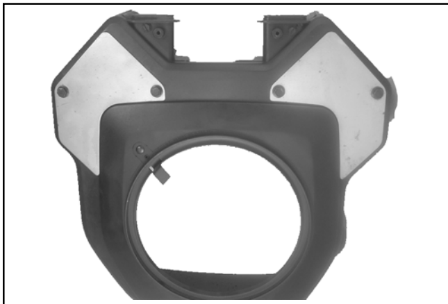
Figura 4-11. Kit di pulizia installato sul convogliatore dell'aria.
