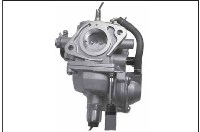
Figura 5-13. Installazione della vaschetta del carburante.
