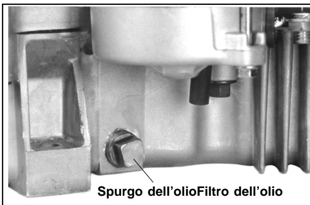
Figura 6-4. Tappo di spurgo dell'olio (lato motorino di avviamento).
