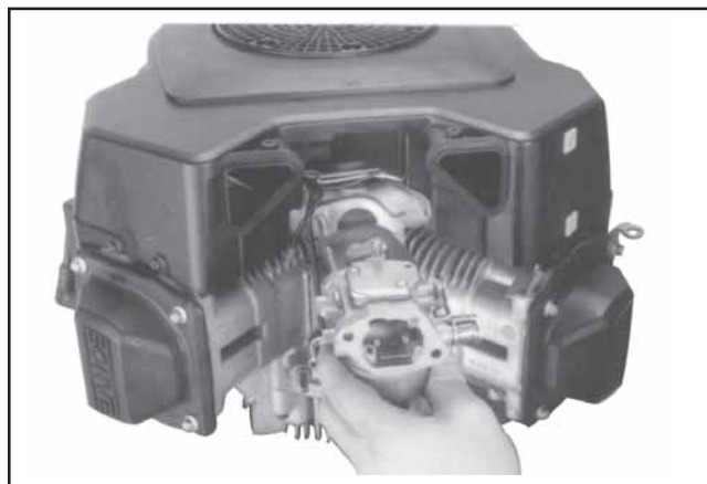
Figura 11-67. Installazione di carburatore, tiranteria e leva del regolatore.
