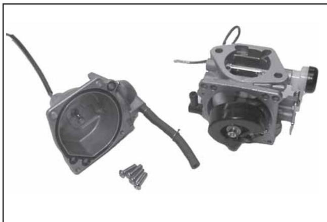
Figura 5-8. Vaschetta del carburante smontata dal carburatore.
