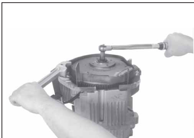
Figura 11-25. Installazione e serraggio della vite di fissaggio del volano.
