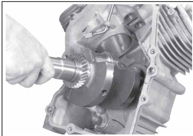
Figura 11-7. Installazione dell'albero motore nel carter.
