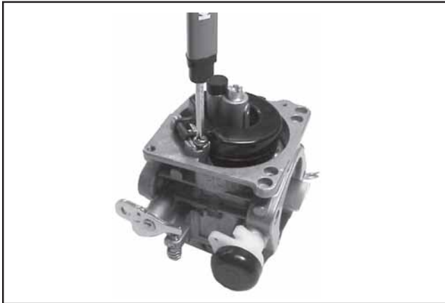
Figura 5-11. Installazione del gruppo galleggiante.
