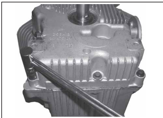
Figura 11-19. Serraggio delle viti della coppa dell'olio.
