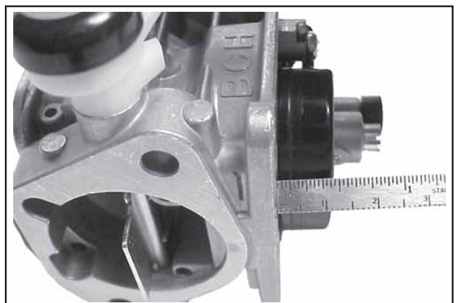
Figura 5-22. Controllo dell'altezza del galleggiante.
