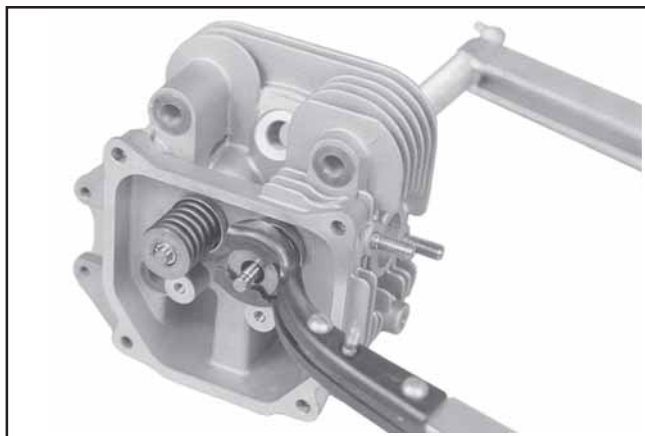
Figura 11-36. Installazione delle valvole con il compressore per molle delle valvole.
