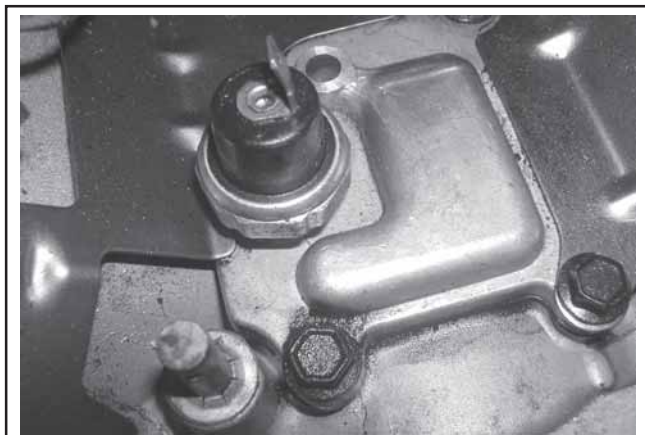
Figura 11-63. Pressostato Oil Sentry™ (alcuni modelli).
