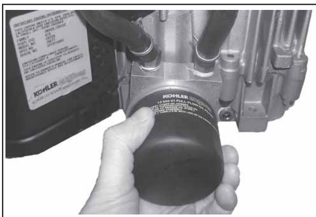
Figura 11-83. Installazione e serraggio del filtro dell'olio.
