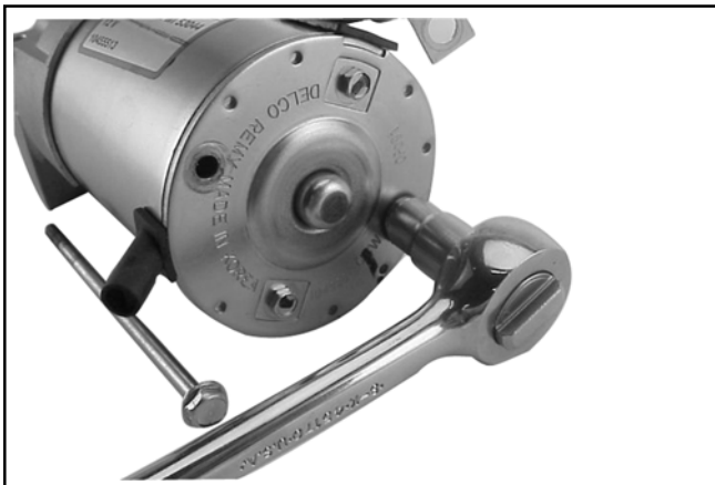
Figura 8-44. Rimozione dei bulloni passanti.
