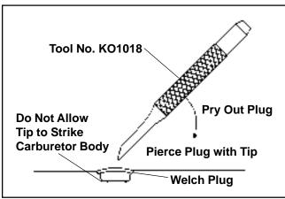
Figure 5-7. Removing Welch Plug.
