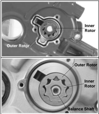
Figure 6-6. Gerotor<sup>™</sup> Oil Pump.
