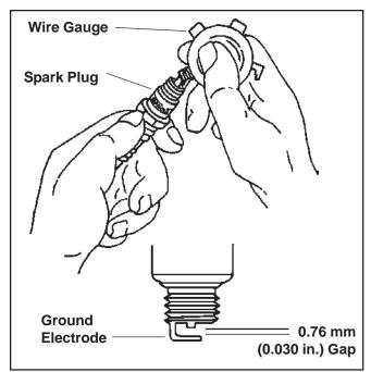
Figure 23. Servicing Spark Plug.
