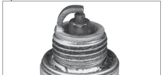
Los depósitos húmedos están originados por exceso de combustible o aceite en la cámara de combustión. El exceso de combustible puede deberse a un filtro de aire obstruido, un problema con el carburador, o un funcionamiento del motor con el estrangulador demasiado cerrado. Normalmente el aceite en la cámara de combustión se debe a un filtro de aire obstruido, un problema con el respirador o un desgaste de los segmentos del pistón o las guías de válvula.
