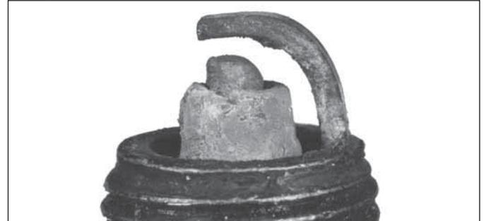
En una bujía gastada, el electrodo central estará redondeado y la separación de electrodos será superior a la separación especificada. Cambie las bujías gastadas inmediatamente.
