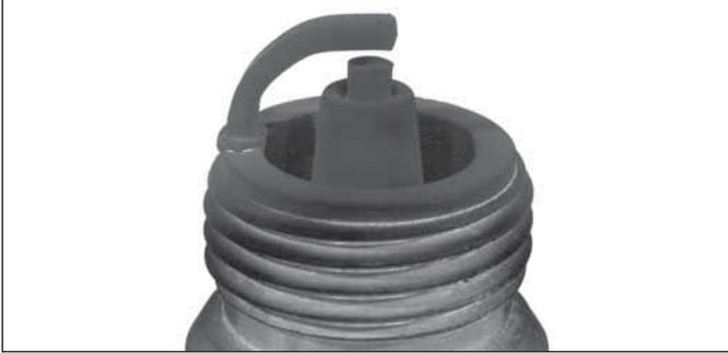
Los depósitos de color negro, blandos, con carbonilla indican una combustión incompleta causada por un filtro de aire obstruido, una carburación con mezcla demasiado rica, defectos de encendido o falta de compresión.
