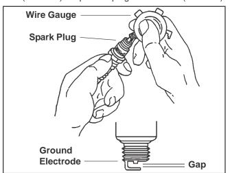
Figure 11. Servicing Spark Plug.
