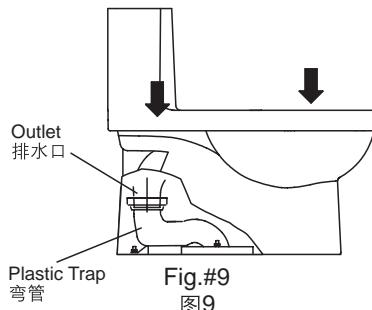
小心对准并将座便器向下放置。同时将座便器边缘向下压，以使排水口插入弯管中。为了要达到最佳的效果，请在安装时确定座便器是否水平。
