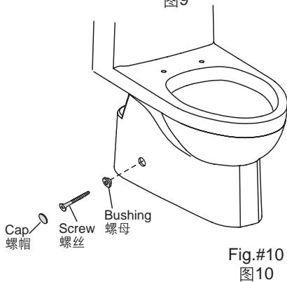
小心的将螺丝旋入支架中直到座便器完全固定。左右交替旋紧以免座便器偏离中心。安装螺帽。
