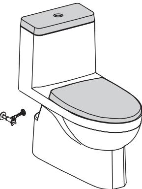
安装水箱盖和盖板。使用附带的盖板安装组件包进行安装。安装后定期检查漏水情况。
