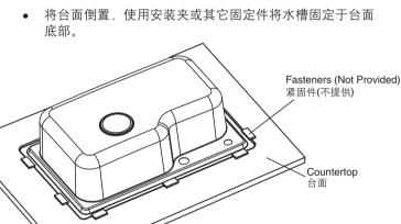
• 拧紧螺丝,将水槽边缘向橱柜台面拉近。请不要拧得过
