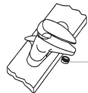
打开排水器。开启主供水源，检查是否有漏水，如有漏水，修理之。
