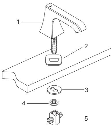
将不干胶垫片(2)贴在出水口底部，将出水口装于脸盆中孔。安装垫片(3)和螺母(4)。调整出水口位置用扳手拧紧螺母(4)。
