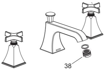
将起泡器(38)取下。打开水龙头的冷热水，让水流出一分钟以清除杂质。冲洗起泡器，关闭阀，重新装回起泡器。
