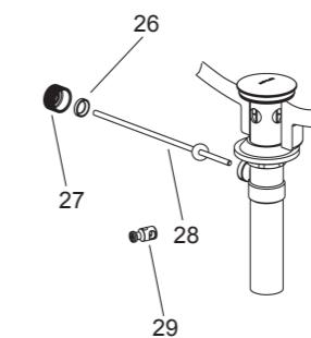
将连接头(29)及固定螺母(27)取下，把塑料垫片(26)及固定螺母装在球杆(28)上，将球杆组件插入排水杆洞口(20)并穿过止水塞孔，拧紧固定螺母。
