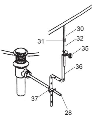
把尾管接上存水弯，尾管须插入存水弯25mm到50mm。
