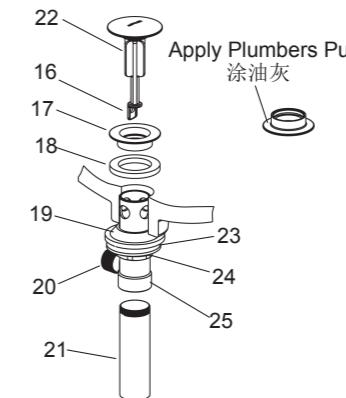
**注意：**如果需要，可直接在法兰盘底面沿周围涂上一圈密封油灰，而不使用垫片(18)。
