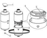
把新滤芯的保护盖(12)和(13)分别从滤 芯两端拔出。拔出滤芯,更换新的滤芯。再按 步骤1中的方法调整数字计时环(4)然后装 回净化器(注意:滤芯安装方向如图所示)。
