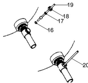
确定球动杆指向洗面盆后方，再次拧紧排水本体的锁紧螺母(13)，去除多余油灰。
