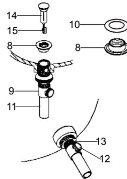
把止水塞(14)放入排水本体中，调整止水塞末端的洞口(15)使其靠近并对正排水杆的洞口。
