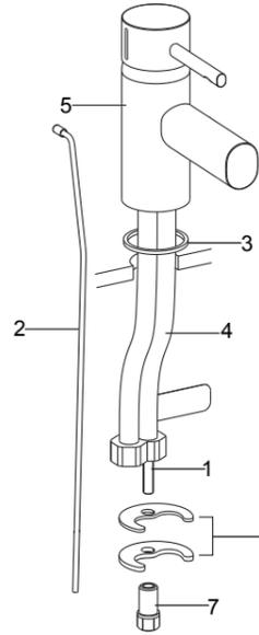
把软管接到水源。当面对龙头时，左边接热水源，右边接冷水源，冷水管贴有“COLD”签。
