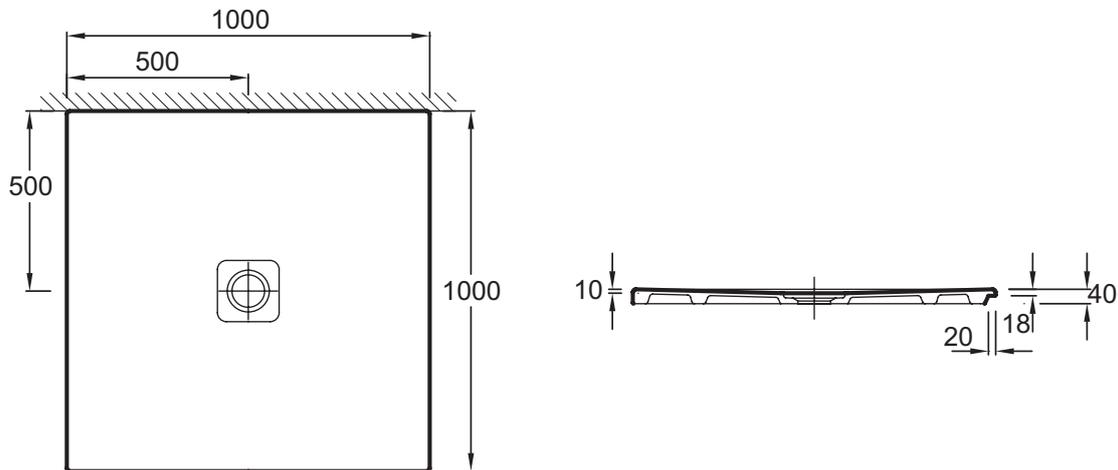
Descriptif CCTP : Receveur affleurant ou à encastrer carré. N141K. Collection : REPLAY. DIMENSIONS : 100 x 100 x 4 cm. POIDS : 37,5 kg. MATÉRIAU : Céramique. TYPE D'INSTALLATION : Posé ou encastré. FORME : Carré. DIAMÈTRE DE BONDE (CM) : 90 mm. Garantie 10 ans.
