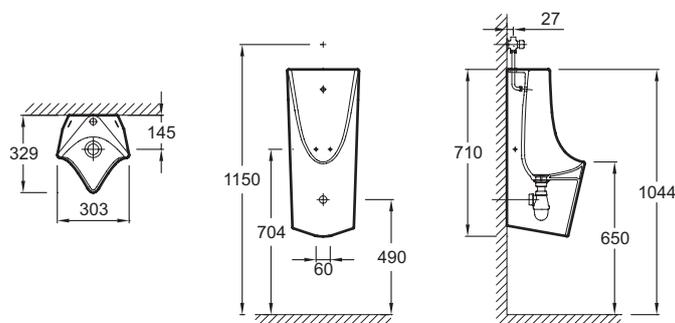
Descriptif CCTP : Urinoir. EZA122. Collection : STRUKTURA. DIMENSIONS : 32,90 x 30,30 cm. POIDS : 17 kg. MATÉRIAU : Céramique. TYPE D'INSTALLATION : Mural. ALIMENTATION : Par-dessus. Alimentation par dessus et évacuation encastrée, livré avec équipement complet (fixations cachées, effet d'eau chromé, flexible de raccordement, tube d'alimentation, bonde à grille et siphon polypropylène.
