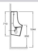
Descriptif CCTP: Urinoir. EZA022. Collection: STRUKTURA. DIMENSIONS: 32,90 x 30,30 cm. POIDS: 17 kg. MATÉRIAU: Céramique. TYPE D'INSTALLATION: Mural. BRIDE: 0. ALIMENTATION: Encastrée. Alimentation et évacuation encastrées, livré avec équipement complet (fixations cachées, effet d'eau chromé, flexible de raccordement, bonde à grille et siphon polypropylène).
