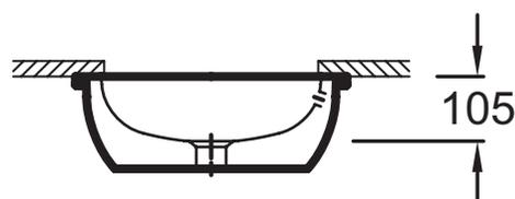
Descriptif CCTP : Vasque à encastrer par-dessous Ø 43 cm. EYM102. Collection : VOX. DIMENSIONS : 43,20 x 43,20 cm. POIDS : 11,5 kg. MATÉRIAU : Céramique. TYPE D'INSTALLATION : Encastré par-dessous. PERCEMENT ROBINETTERIE : Sans trou de robinetterie. CONFIGURATION : STANDARD. MEULÉ/NON-MEULÉ : Meulé. TROP-PLEIN : Avec trou de trop-plein. LIVRÉ AVEC : Kit de fixation.
