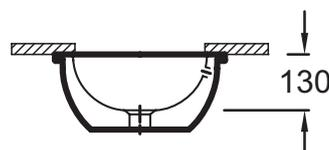
Descriptif CCTP : Vasque à encastrer par-dessous 56 cm. EYG102. Collection : VOX. DIMENSIONS : 56,20 x 39,20 cm. POIDS : 13,3 kg. MATÉRIAU : Céramique. TYPE D'INSTALLATION : Encastré par-dessous. PERCEMENT ROBINETTERIE : Sans trou de robinetterie. CONFIGURATION : STANDARD. MEULÉ/NON-MEULÉ : Meulé. TROP-PLEIN : Avec trou de trop-plein. NOMBRE DE VASQUES : Simple vasque. LIVRÉ AVEC : Kit de fixation.
