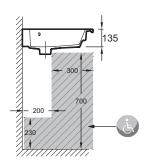
Descriptif CCTP: Plan-vasque céramique, 140 cm, meulé. EXAS112-Z. Collection: ODÉON RIVE GAUCHE. DIMENSIONS: 140 x 51 cm. POIDS: 37 kg. MATÉRIAU: Céramique. TYPE D'INSTALLATION: Autoportant. PERCEMENT ROBINETTERIE: Percé 1 trou. CONFIGURATION: STANDARD. MEULÉ/NON-MEULÉ: Meulé. TROP-PLEIN: Avec trou de trop-plein. NOMBRE DE VASQUES: Double vasque. ROBINETTERIE CONSEILLÉE: Odéon Rive Gauche (plusieurs choix de finitions). INFOS COMPLÉMENTAIRES: Bonde et robinetterie non incluses.
