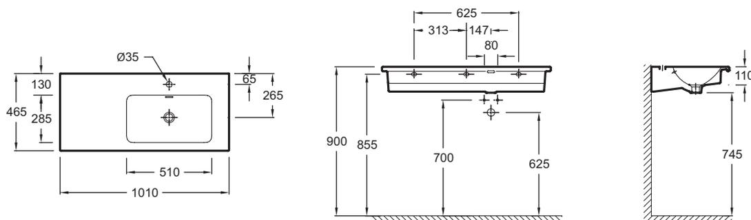
Descriptif CCTP : Plan-vasque céramque, 101 cm, droite, meulé. EXAD112-Z. Collection : VOX. DIMENSIONS : 100 x 46 cm. POIDS : 26 kg. MATÉRIAU : Céramique. TYPE D'INSTALLATION : Autoportant. NORMES ET RÉGLEMENTATIONS : NF. PERCEMENT ROBINETTERIE : Percé 1 trou. CONFIGURATION : STANDARD. MEULÉ/NON-MEULÉ : Meulé. TROP-PLEIN : Avec trou de trop-plein. NOMBRE DE VASQUES : Simple vasque. INFOS COMPLÉMENTAIRES : bonde et robinetterie non incluses.
