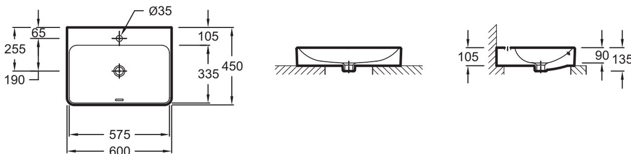
Descriptif CCTP : Vasque à poser 60 cm. EVD112. Collection : VOX. DIMENSIONS : 60 x 45 cm. POIDS : 16,1 kg. MATÉRIAU : Céramique. TYPE D'INSTALLATION : Posé. PERCEMENT ROBINETTERIE : Percé 1 trou. CONFIGURATION : STANDARD. MEULÉ/NON-MEULÉ : Meulé. TROP-PLEIN : Avec trou de trop-plein. INFOS COMPLÉMENTAIRES : robinetterie non incluse. LIVRÉ AVEC : Cache trop-plein.
