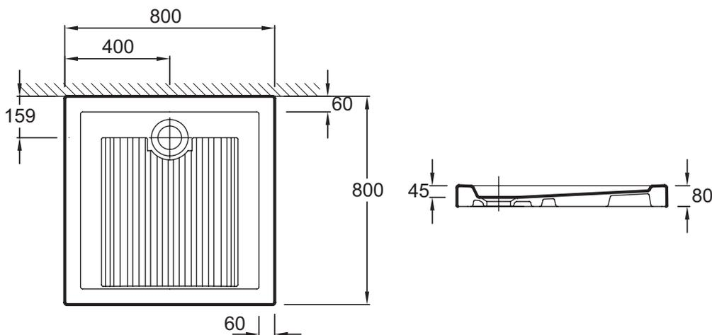
Descriptif CCTP : Receveur à poser carré, bonde à l'arrière. EN163. Collection : KYREO. DIMENSIONS : 80 x 80 x 8 cm. POIDS : 29,4 kg. MATÉRIAU : Céramique. TYPE D'INSTALLATION : Posé. FORME : Carré. DIAMÈTRE DE BONDE (CM) : 90 mm. VERSION : A poser. LIVRÉ AVEC BONDE : Oui.
