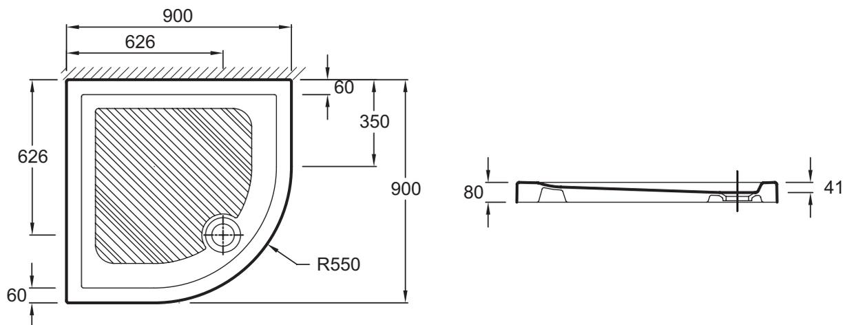
Descriptif CCTP : Receveur à poser quart de rond, bonde à l'avant. EN107. Collection : KYREO. DIMENSIONS : 90 x 90 x 8 cm. POIDS : 36,2 kg. MATÉRIAU : Céramique. TYPE D'INSTALLATION : Posé. FORME : Quart de rond. DIAMÈTRE DE BONDE (CM) : 90 mm. Garantie 10 ans.
