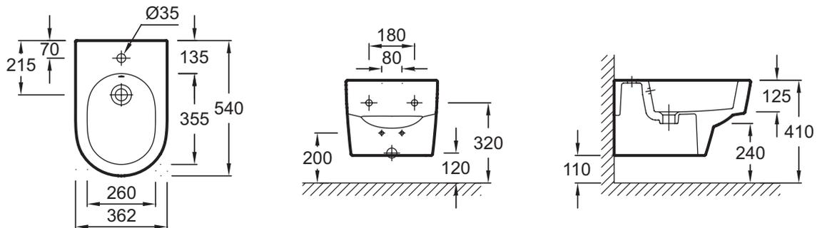
Descriptif CCTP : Bidet suspendu. EMG0002. Collection : ODÉON RIVE GAUCHE. DIMENSIONS : 54 x 36,20 cm. POIDS : 20 kg. MATÉRIAU : Céramique. TYPE D'INSTALLATION : Suspendu. HAUTEUR : Confort. TYPE DE BRIDE : Sans bride. GARANTIE DE LA CÉRAMIQUE : 10 ans. CONDITIONNEMENT : 1 colis. FIXATION DE LA CUVETTE : Invisibles.
