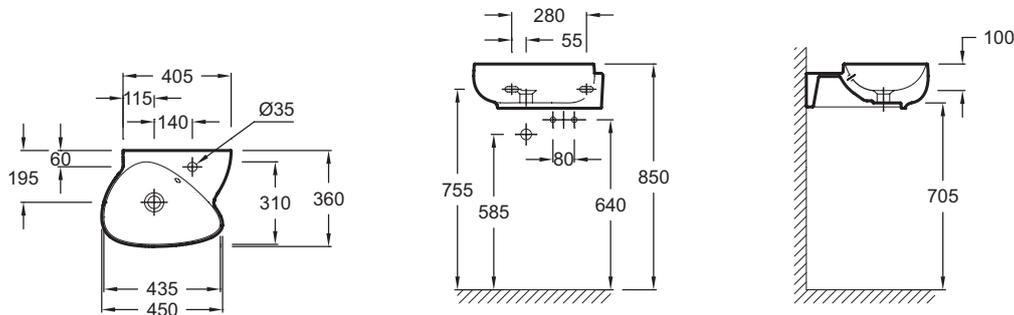
Descriptif CCTP : Lave-mains 45 cm. EGK112. Collection : NOUVELLE VAGUE. DIMENSIONS : 45 x 36 cm. POIDS : 12 kg. MATÉRIAU : Céramique. TYPE D'INSTALLATION : Autoportant. PERCEMENT ROBINETTERIE : Percé 1 trou. TROP-PLEIN : Avec trou de trop-plein. LIVRÉ AVEC : Clapet de bonde. ROBINETTERIE CONSEILLÉE : Nouvelle Vague. INFOS COMPLÉMENTAIRES : robinetterie non incluse.
