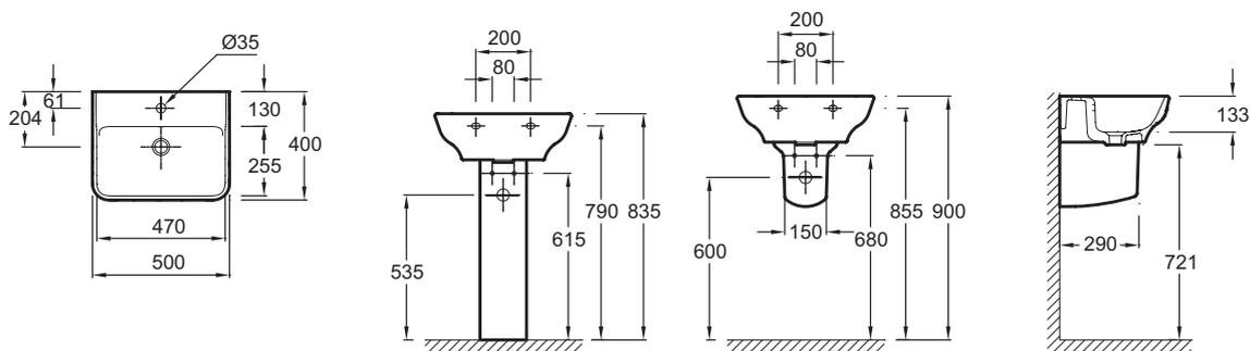
Descriptif CCTP : Lavabo 50 cm non meulé. EGF111. Collection : STRUKTURA. DIMENSIONS : 50 x 40 cm. POIDS : 13,6 kg. TYPE D'INSTALLATION : Autoportant. PERCEMENT ROBINETTERIE : Percé 1 trou. CONFIGURATION : STANDARD. MEULÉ/NON-MEULÉ : Non meulé. TROP-PLEIN : Avec trou de trop-plein. NOMBRE DE VASQUES : Simple vasque. INFOS COMPLÉMENTAIRES : robinetterie non incluse.
