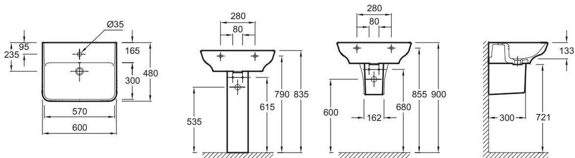
Descriptif CCTP : Lavabo 60 cm. EGD111. Collection : STRUKTURA. DIMENSIONS : 60 x 48 cm. MATÉRIAU : Céramique. TYPE D'INSTALLATION : Autoportant. NORMES ET RÉGLEMENTATIONS : NF. PERCEMENT ROBINETTERIE : Percé 1 trou. CONFIGURATION : STANDARD. MEULÉ/NON-MEULÉ : Non meulé. TROP-PLEIN : Avec trou de trop-plein. NOMBRE DE VASQUES : Simple vasque. INFOS COMPLÉMENTAIRES : robinetterie non incluse.
