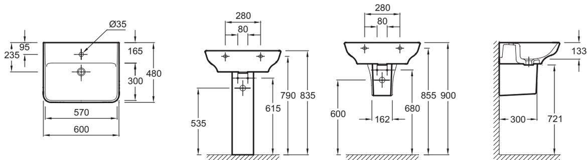
Descriptif CCTP : Lavabo 60 cm non meulé. EGD011. Collection : STRUKTURA. DIMENSIONS : 60 x 48 cm. POIDS : 18 kg. MATÉRIAU : Céramique. TYPE D'INSTALLATION : Autoportant. NORMES ET RÉGLEMENTATIONS : NF. PERCEMENT ROBINETTERIE : Percé 1 trou. CONFIGURATION : STANDARD. MEULÉ/NON-MEULÉ : Non meulé, pour une installation seule, sans meuble ou sans plan de travail. TROP-PLEIN : Sans trou de trop-plein. NOMBRE DE VASQUES : Simple vasque. INFOS COMPLÉMENTAIRES : robinetterie non incluse.
