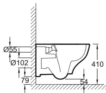
Descriptif CCTP : Cuvette suspendue SANS BRIDE. EDE001. Collection : STRUKTURA. DIMENSIONS : 54 x 34 cm. POIDS : 25 kg. MATÉRIAU : Céramique. TYPE D'INSTALLATION : Suspendu. CONSOMMATION D'EAU : 2,6/4 L et 3/6 L. HAUTEUR : Confort. TYPE DE BRIDE : Sans bride. BRIDE : 0. ABATTANT : 0.
