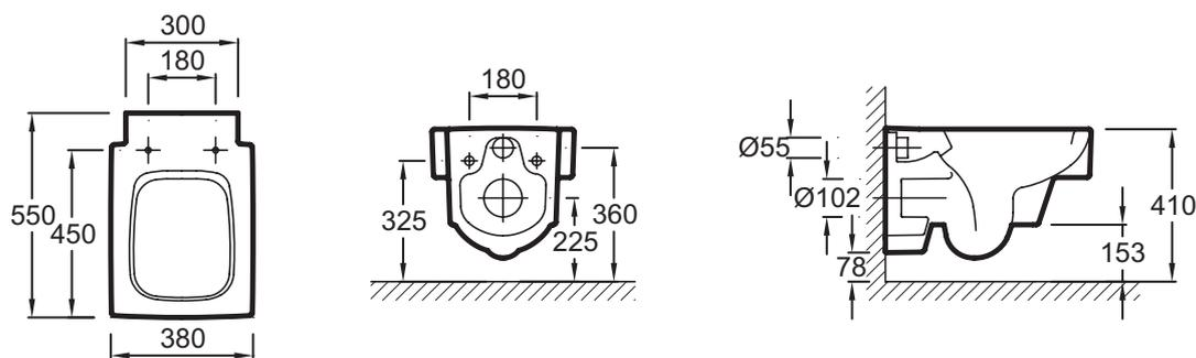
Descriptif CCTP : Cuvette suspendue carénée. EDA102. Collection : TERRACE. DIMENSIONS : 55 x 38 cm. POIDS : 25,3 kg. MATÉRIAU : Céramique. TYPE D'INSTALLATION : Suspendu. CONSOMMATION D'EAU : 2,6/4 L et 3/6 L. HAUTEUR : Réglable de 38 à 50 cm. BRIDE : 0. PRODUIT INCLUS : (abattant non inclus).
