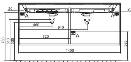
Descriptif CCTP : Meuble sous plan-vasque 140 cm, 1 tiroir/1 niche/2 portes. EB2556-RX. Collection : ODÉON RIVE GAUCHE. DIMENSIONS : 140 x 50,80 x 56,80 cm. POIDS : 36,9 kg. MATÉRIAU : Laque ou mélaminé. TYPE D'INSTALLATION : Suspendu.
