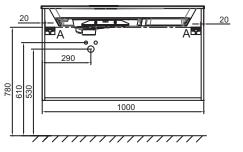
Descriptif CCTP : Meuble sous plan-vasque 100 cm, 2 tiroirs. EB2524-R9. Collection : ODÉON RIVE GAUCHE. DIMENSIONS : 100 x 50,80 x 56,80 cm. POIDS : 36,7 kg. MATÉRIAU : Laque ou mélaminé. TYPE D'INSTALLATION : Suspendu. VERSION : Avec passe-siphon. DISPOSITION VASQUE : Gauche. POIGNÉE : Noir. FINITION INTÉRIEURE : Gris.
