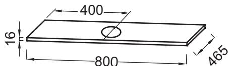
Descriptif CCTP : Plateau 80 cm, 1 découpe. EB2131. Collection : VOX. DIMENSIONS : 80 x 46,50 x 1,60 cm. POIDS : 5 kg. MATÉRIAU : Laque ou mélaminé. TYPE MEUBLE DE COMPLÉMENT : Plateau. TYPE D'ACCESSOIRES DE MEUBLE : Plateau. FIXATION : Set de fixation à déterminer par votre installateur en fonction de votre support mural.
