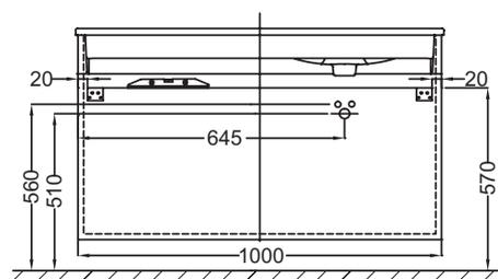
Descriptif CCTP : Meuble sous plan-vasque 100 cm (cuve à gauche), 3 tiroirs. EB2095-RX. Collection : VOX. POIDS : 42 kg. MATÉRIAU : Laque ou mélaminé. TYPE D'INSTALLATION : Mural. NORMES ET RÉGLEMENTATIONS : NF.
