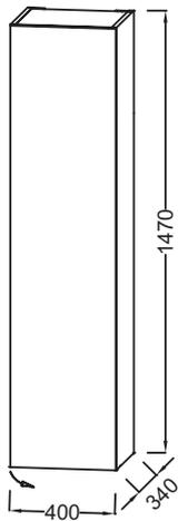
Descriptif CCTP : Colonne 40 cm, version droite. EB1850D. Collection : HORS COLLECTION. DIMENSIONS : 40 x 34 x 147 cm. POIDS : 23 kg. MATÉRIAU : Laque ou mélaminé. TYPE D'INSTALLATION : Mural. PRISE ÉLECTRIQUE : Non. PRISE USB : Non. ANTIBUÉE : Non. HORLOGE : Non. TYPE MEUBLE DE COMPLÉMENT : Colonne. FINITION INTÉRIEURE : Gris.
