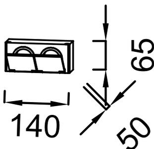
Descriptif CCTP : Boîtier 2 prises électriques. EB1555. Collection : ODÉON RIVE GAUCHE. DIMENSIONS : 14 x 5 x 6,50 cm. POIDS : 0,4 kg. MATÉRIAU : Plastique. ÉLECTRICITÉ : 220V. PRISE ÉLECTRIQUE : Oui. TYPE D'ACCESSOIRES DE MEUBLE : Prise.
