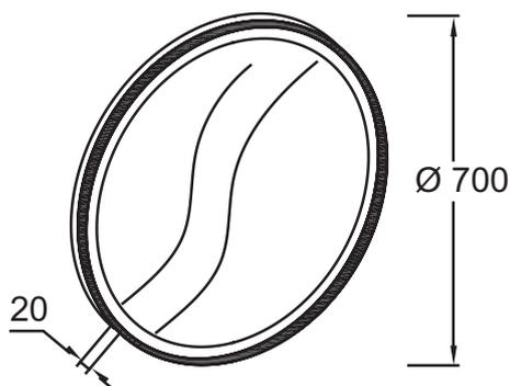
Descriptif CCTP : Miroir rond Ø 70 cm. EB1289. Collection : Hors collection. TYPE D'INSTALLATION : Mural. ÉLECTRICITÉ : 230V, 22W, classe II IP44. LUMIÈRE : Oui. PRISE ÉLECTRIQUE : Non. PRISE USB : Non. ANTIBUÉE : Non. HORLOGE : Non.
