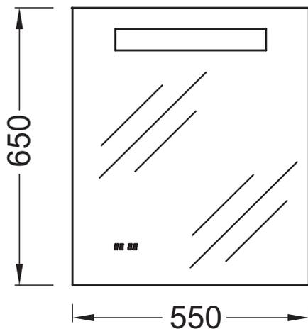
Descriptif CCTP : Miroir 55 cm, éclairage LED, anti-buée et horloge. EB1158. Collection : Hors collection. DIMENSIONS : 55 x 3 x 65 cm. POIDS : 7 kg. TYPE D'INSTALLATION : Mural. ÉLECTRICITÉ : 230V, 5W, classe II IP44. LUMIÈRE : Oui. PRISE ÉLECTRIQUE : Non. PRISE USB : Non. ANTIBUÉE : Oui. HORLOGE : Oui. INFORMATIONS COMPLÉMENTAIRES : Allumage par simple passage de la main ; on/off, à droite..
