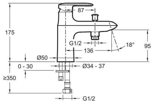
Descriptif CCTP : Mitigeur bain-douche monotrou. E99458. Collection : KUMIN. POIDS : 1,6 kg. NORMES ET RÉGLEMENTATIONS : ACS : 10 ACC LY 113 / NF ECAU : E3/1 C2 A2 U3 (Ge3). TYPE : Mitigeur. DÉBIT (L/MN SOUS 3 BARS) : 20 l/mn. HAUTEUR TOTALE DU ROBINET (MM) : 175. SAILLIE DU BEC (MM) : 132. RACCORDS : Avec raccords colonnettes. MÉCANISME : Cartouche à disques céramique. CLAPET ANTI-RETOUR : Oui. INVERSEUR : Automatique verrouillable. GARANTIE MÉCANISME : 5 ans. Clapet anti-retour.
