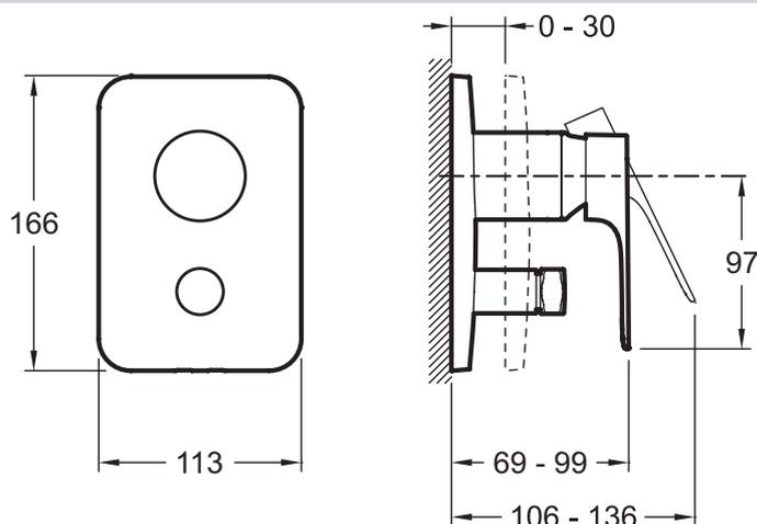
Descriptif CCTP : Mitigeur mécanique avec deux sorties, façade Aleo+. E98718. Collection : ALEO+. DIMENSIONS : 24,50 x 16,50 x 11,50 cm. POIDS : 2,4 kg. TYPE D'INSTALLATION : Encastré. NORMES ET RÉGLEMENTATIONS : ACS : 10 ACC LY 004. TYPE DE SYSTÈME DE ROBINETTERIE DE BAIN : Avec Système Modulo. COMPOSITION : un corps à encastrer, une façade, une poignée et un inverseur. A connecter à deux sorties (exemple : douche de tête, douchette à main, bec bain...).
