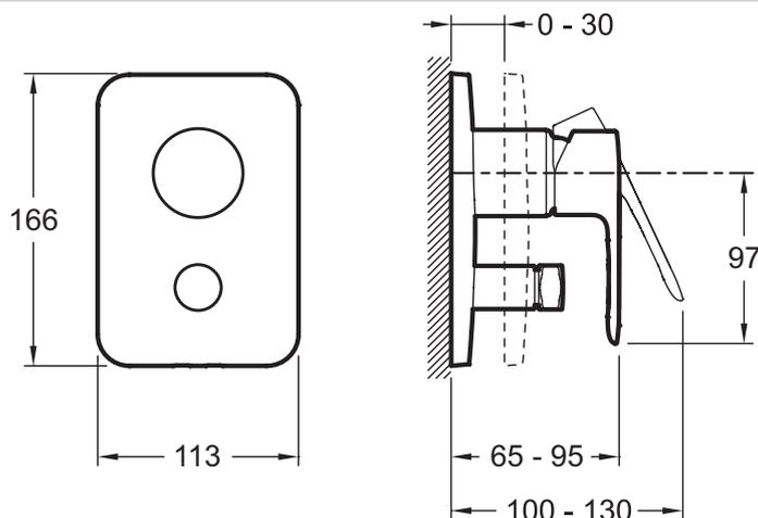
Descriptif CCTP : Mitigeur mécanique avec deux sorties. E98714. Collection : JULY. DIMENSIONS : 24,50 x 16,50 x 11,50 cm. POIDS : 2,6 kg. TYPE D'INSTALLATION : Encastré. NORMES ET RÉGLEMENTATIONS : ACS : 10 ACC LY 004. Inverseur automatique verrouillable.
