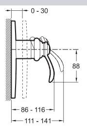
Descriptif CCTP: Mitigeur mécanique à encastrer - sans inverseur - façade et levier Fairfax. E98710. Collection: FAIRFAX. POIDS: 1,9 kg. TYPE D'INSTALLATION: Encastré. NORMES ET RÉGLEMENTATIONS: ACS: 10 ACC LY 004. Installation avec le boîtier universel Modulo 98699D.
