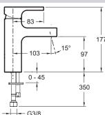
Descriptif CCTP : Mitigeur lavabo - modèle medium - corps lisse. E98339. Collection : STRAYT. POIDS : 2,6 kg. TYPE : Mitigeur. RACCORDS : Avec flexibles d'alimentation. MÉCANISME : Cartouche à disques céramique. VIDAGE : Sans vidage. TYPE D'INSTALLATION : 1 trou. GARANTIE MÉCANISME : 5 ans. Aérateur anti-calcaire intégré. Sans bonde de vidage.
