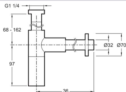
Descriptif CCTP : Siphon "design", modèle long. E78291. Collection : Hors collection. POIDS : 1 kg. TYPE D'ACCESSOIRE : Siphon.
