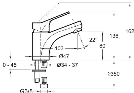
Descriptif CCTP : Mitigeur lavabo - avec système d'installation breveté 5I35". E75762-4. Collection : BRIVE. POIDS : 1,3 kg. TYPE D'INSTALLATION : 1 trou. NORMES ET RÉGLEMENTATIONS : NF : I - ECAU : E00 Ch2 A3 U3 (Ps3) - ACS : 15 ACC LY 472. TYPE : Mitigeur. DÉBIT (L/MN SOUS 3 BARS) : 5 l/mn. HAUTEUR TOTALE DU ROBINET (MM) : 136. SAILLIE DU BEC (MM) : 103. RACCORDS : Avec flexibles d'alimentation. MÉCANISME : Cartouche à disques céramique. VIDAGE : Sans vidage. GARANTIE MÉCANISME : 5 ans.
