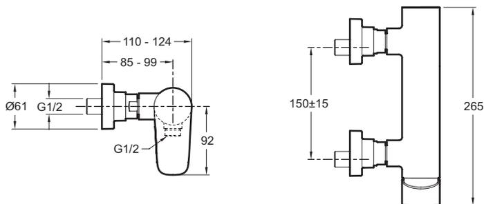
Descriptif CCTP : Mitigeur douche mural. E72351. Collection : ALEO. POIDS : 1,9 kg. TYPE D'INSTALLATION : Mural. NORMES ET RÉGLEMENTATIONS : NF : IA - ECAU : E1 C2 A3 U3 (Ge3) - ACS : 10 ACCLY 113. TYPE : Mitigeur. DÉBIT (L/MN SOUS 3 BARS) : 14 l/mn. RACCORDS : Avec raccords et rosaces murales. MÉCANISME : Cartouche à disques céramique. ENTRAXE (MM) : 150 ± 15. TYPE D'INSTALLATION : 2 trous. CLAPET ANTI-RETOUR : Oui. GARANTIE MÉCANISME : 5 ans. GARANTIE FINITION : 10 ans.
