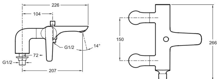
Descriptif CCTP : Mitigeur bain-douche sur gorge. E72320. Collection : ALEO+. POIDS : 3 kg. NORMES ET RÉGLEMENTATIONS : ACS : 10 ACC LY 113. TYPE : Mitigeur. DÉBIT (L/MN SOUS 3 BARS) : 26 l/mn. SAILLIE DU BEC (MM) : 208. RACCORDS : Avec raccords colonnettes. MÉCANISME : Cartouche à disques céramique. ENTRAXE (MM) : 150. MITIGEUR DE BAIN : Mécanique. INVERSEUR : Automatique à bouton-poussoir. GARANTIE MÉCANISME : 5 ans.
