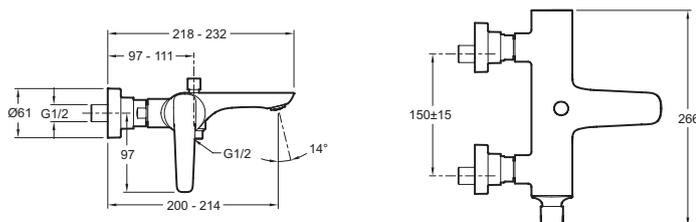
Descriptif CCTP : Mitigeur bain-douche mural. E72319. Collection : ALEO+. POIDS : 2,3 kg. TYPE D'INSTALLATION : Mural. NORMES ET RÉGLEMENTATIONS : ACS : 10 ACC LY 113. TYPE : Mitigeur. DÉBIT (L/MN SOUS 3 BARS) : 26 l/mn. SAILLIE DU BEC (MM) : 218 - 232. RACCORDS : Avec raccords et rosaces murales. MÉCANISME : Cartouche à disques céramique. ENTRAXE (MM) : 150 ± 15. MITIGEUR DE BAIN : Mécanique. INVERSEUR : Automatique à bouton-poussoir. GARANTIE MÉCANISME : 5 ans.
