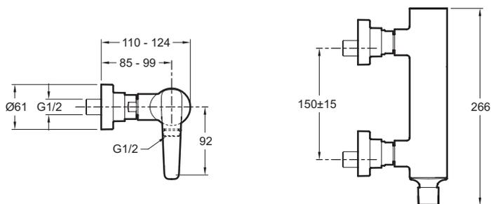
Descriptif CCTP : Mitigeur douche mural. E72318. Collection : ALEO+. POIDS : 1,9 kg. TYPE D'INSTALLATION : Mural. NORMES ET RÉGLEMENTATIONS : ACS : 10 ACC LY 113. TYPE : Mitigeur. DÉBIT (L/MN SOUS 3 BARS) : 14 l/mn. RACCORDS : Avec raccords et rosaces murales. MÉCANISME : Cartouche à disques céramique. ENTRAXE (MM) : 150 ± 15. TYPE D'INSTALLATION : 2 trous. GARANTIE MÉCANISME : 5 ans.
