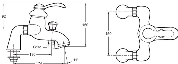
Descriptif CCTP : Mitigeur bain-douche sur gorge. E71091. Collection : FAIRFAX. POIDS : 2,7 kg. TYPE : Mitigeur. DÉBIT (L/MN SOUS 3 BARS) : 20 l/mn. RACCORDS : Avec raccords colonnettes. MÉCANISME : Cartouche à disques céramique. ENTRAXE (MM) : 150. VIDAGE : Avec vidage. INVERSEUR : Automatique verrouillable. GARANTIE MÉCANISME : 5 ans.
