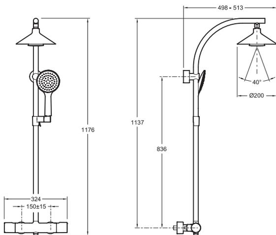
Descriptif CCTP : Colonne de douche thermostatique grand modèle + haut-parleur. E5799. Collection : MOXIE. POIDS : 7 kg. NORMES ET RÉGLEMENTATIONS : ACS : 10 ACC LY 277. AVEC OU SANS ROBINETTERIE : AVEC ROBINETTERIE. MITIGEUR : THERMOSTATIQUE. TYPOLOGIE DE ROBINETTERIE DE DOUCHE : Thermostatique. BUTÉE DE SÉCURITÉ : 40°C. Flexible de douche lisse anti-torsion.
